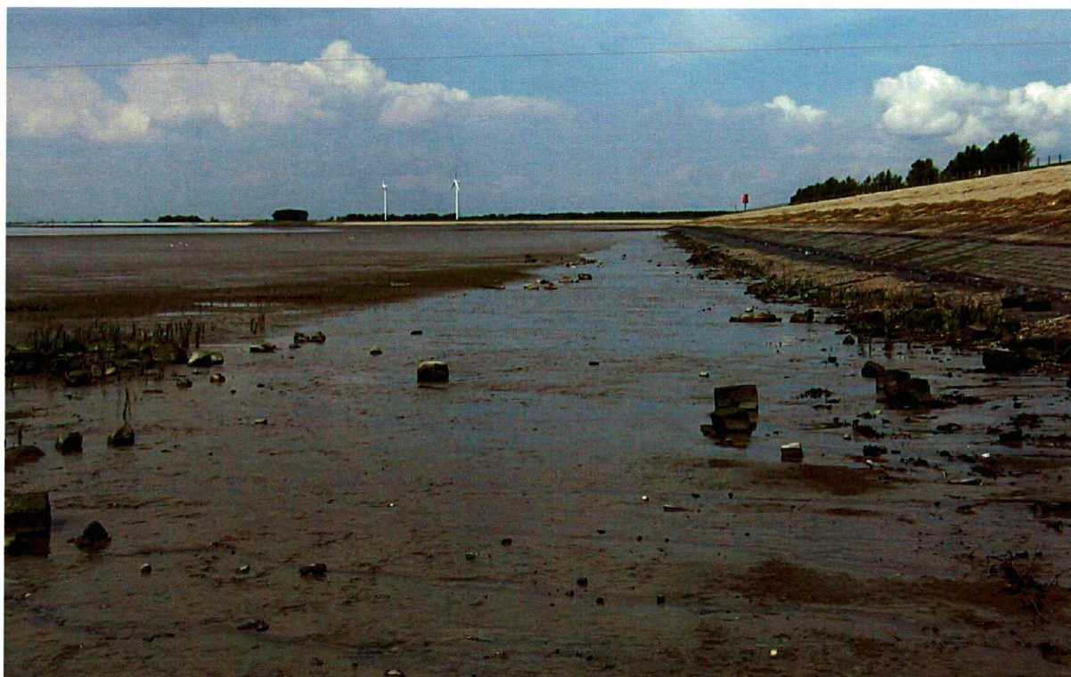
Foto 34 Proefstrook 26, Paviljoenpolder: een duidelijk nattere baan loopt parallel aan de dijk, dit lijkt een effect van de werkstrook te zijn maar wordt waarschijnlijk veroorzaakt door uittredend water aan de voet van de dijk.
