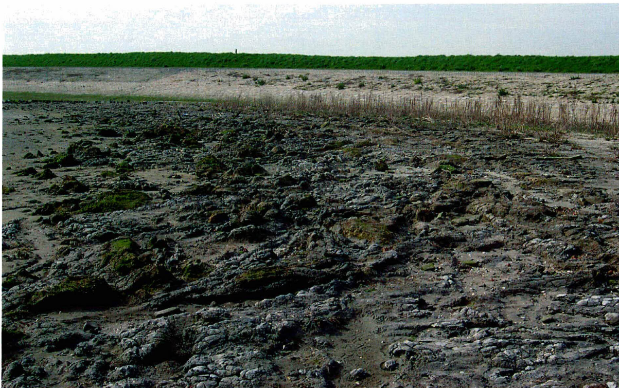
Foto 21 Proefstrook 13, Biezelingse Ham: vergraven schor is gevoeliger voor erosie. Door het vergraven is het verband weg en spoelen zandige delen makkelijker weg en blijven er hompen klei, afgerond door erosie, over.
