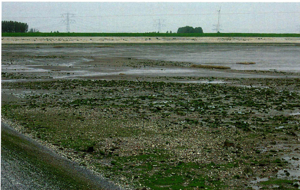
Foto 22 Proefstrook 14, Biezelingse Ham: op een paar kleine plekjes na is het primaire schor hier verdwenen en vervangen door een met stenen bezaaid slik.
