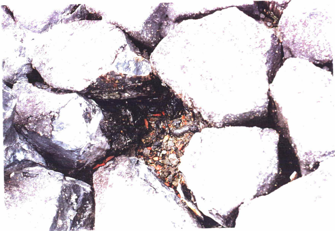
Foto 9 Gat bij km 37,125. De penetratie lijkt hier minder goed geslaagd, maar is wel doorgelopen tot op het filter.
