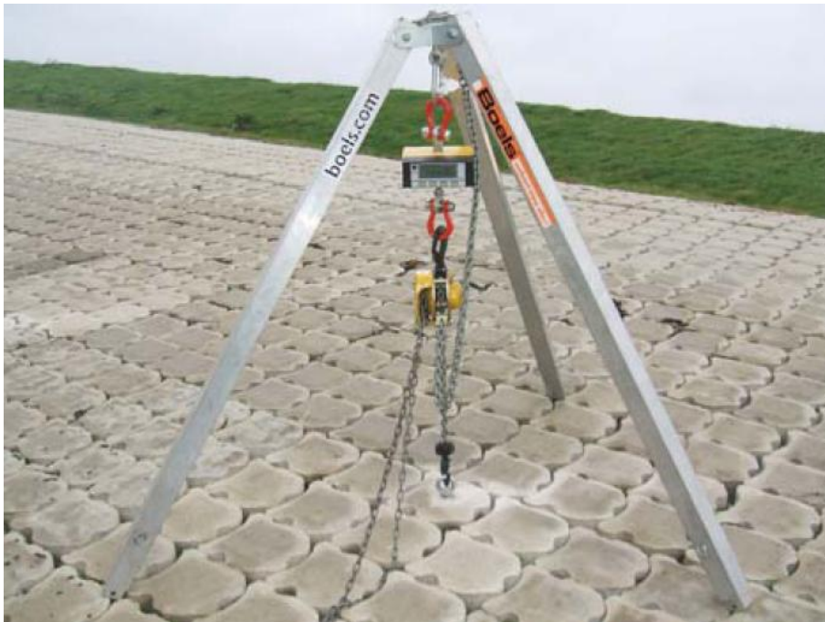
Figuur 2.3 Driepoot met handtakel en digitale unster
