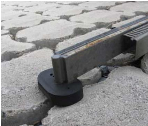
Figuur 2.5 Rubbervoet als steunpunt op het talud voor de geofoonbalk
