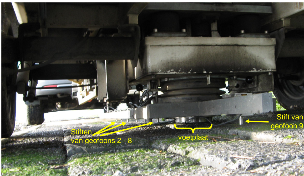
Figuur 2.7 Vanaf de achterzijde zijn onder de aanhangwagen de voetplaat van het valgewicht en de stiften van de gefoons te zien
