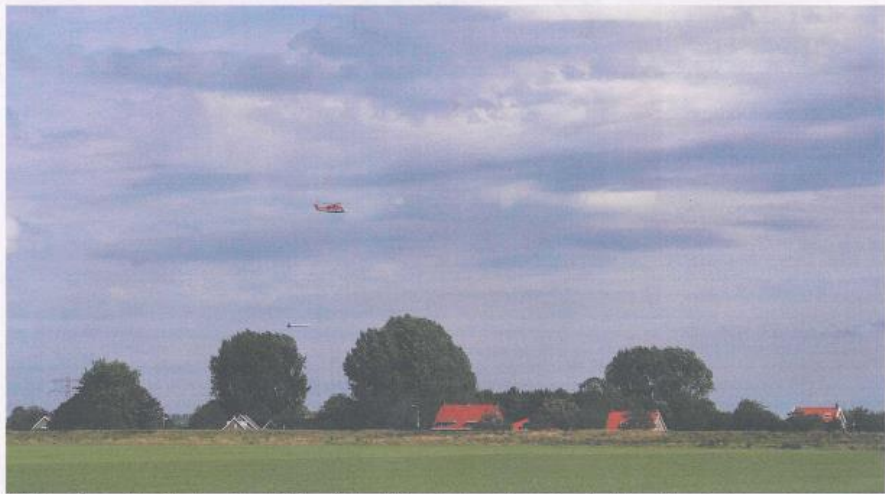
Het HEM-systeem onder de helikopter meet de elektrische geleidbaarheid van de ondergrond gecombineerd met die van het grondwater.
