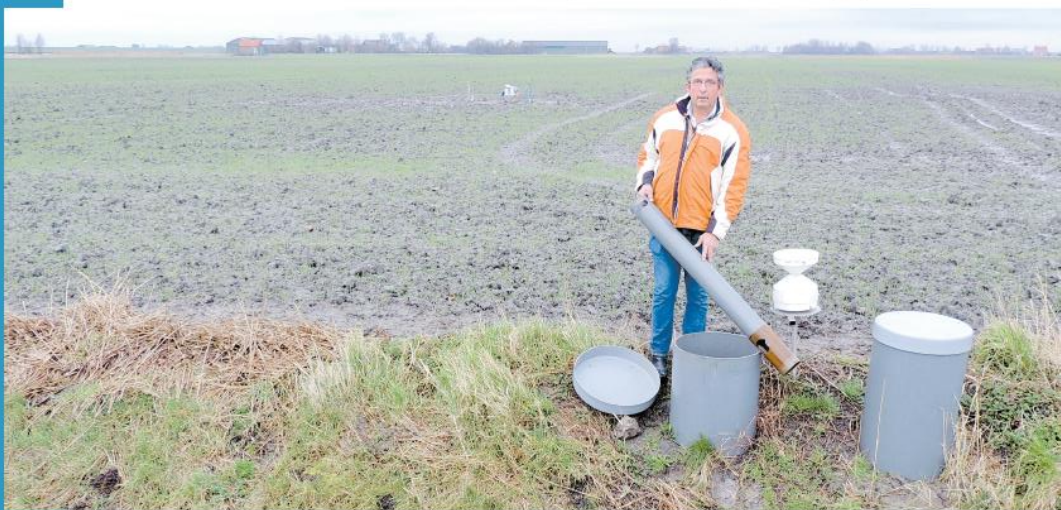
Rien van de Hoek meet een van de kokers waarmee hij de peilgestuurde drainage regelt. Links achter hem een meetpunt voor zoute kwel.
