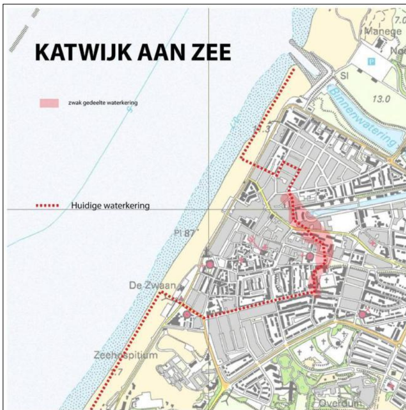
Afbeelding 5 Huidige waterkering en zwakke gedeelte
