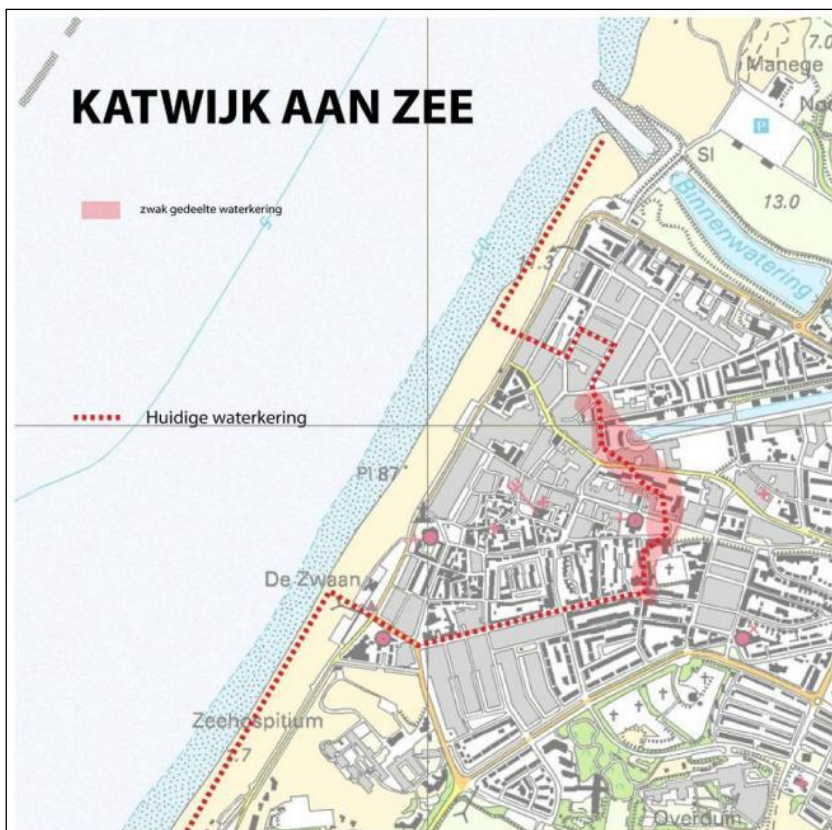
Afbeelding 1 Huidige waterkering en zwakke gedeelte
