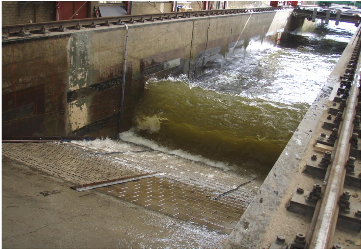
Foto C.4.1: Naderende golfklap met veel turbulentie rond kabels a.g.v. golfneerloop
