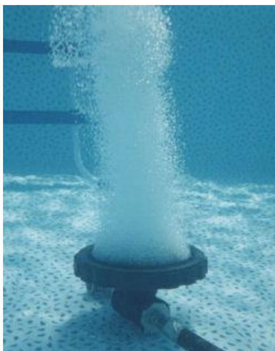
Figuur 4.4 Contractie in de verdeling van lucht van een bellenpluim (met dank aan Ken O'Hara/Flowthrough).
