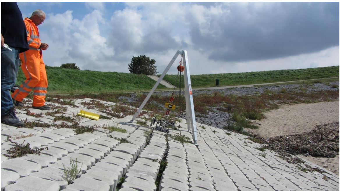
Figuur 2.1 Trekproef op slecht gezette Hydroblocks.
