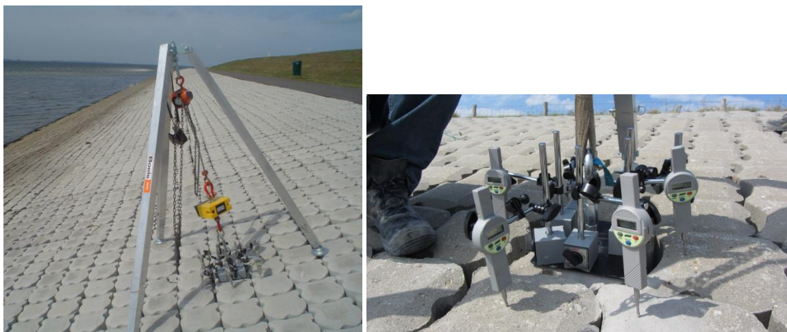
Figuur 2.2 Uitvoering trekproeven met driepoot, takel en unster (links) en klokjes op de te trekken steen om de beweging te registreren (rechts).
