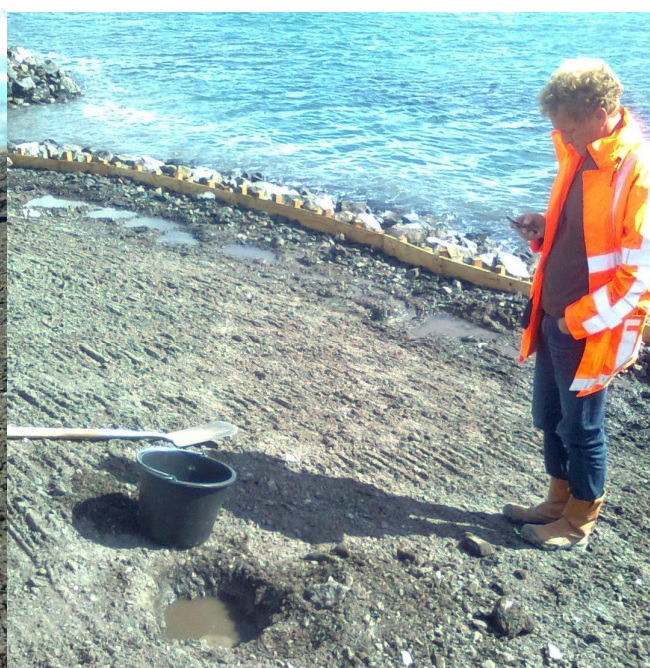
Foto 6: Infiltratiekuil indicatieve beoordeling doorlatendheid (Roggenplaat)
