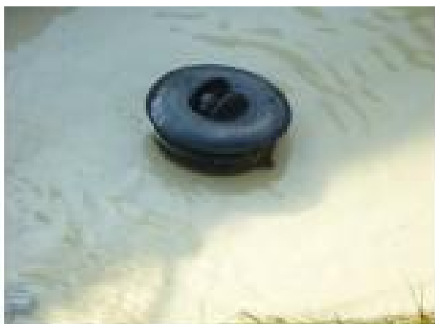
Figuur 4-4: Paddle wiel voor registratie stroomsnelheid aan de bodem
