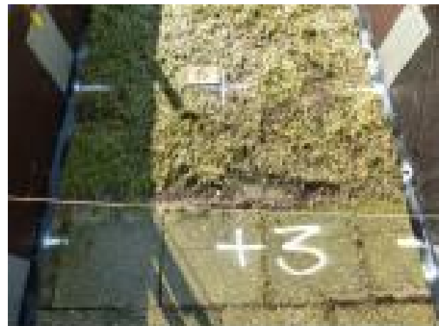
Figuur T3-4: proef 3-0 22:52 uur, afgerond, de overgang tussen de berm en het grasmatt
