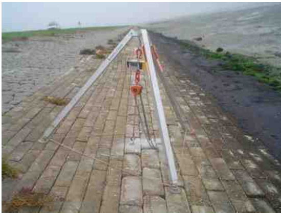
Figuur 2.1 Trekproef in uitvoering (Grevelingendam)
