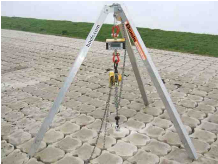
Figuur 2.2 Driepoot met handtakel en digitale unster.
