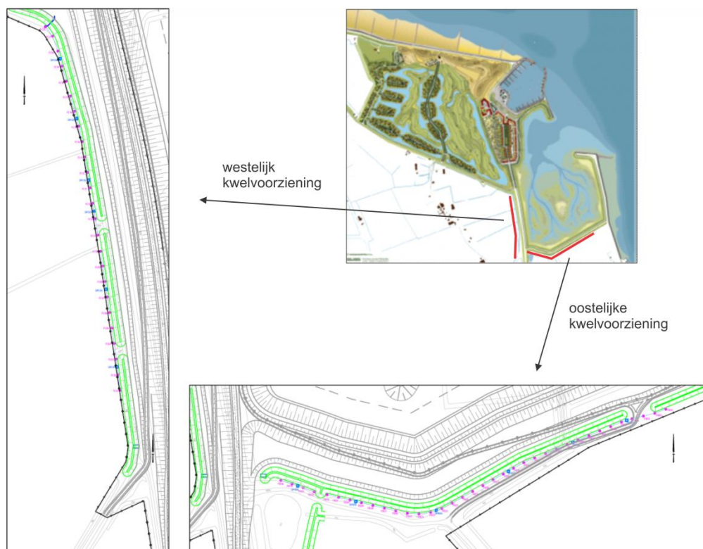
Figuur 2. De ligging van de geplande westelijke en oostelijke kwelvoorziening. Op de detailtekening geven de roze punten de positie van de verticale kwelbuizen weer en in blauw zijn de regelputten weergegeven. Voor details van de kwelvoorziening wordt verwezen naar de technische uitwerking van Van Oord BV.
