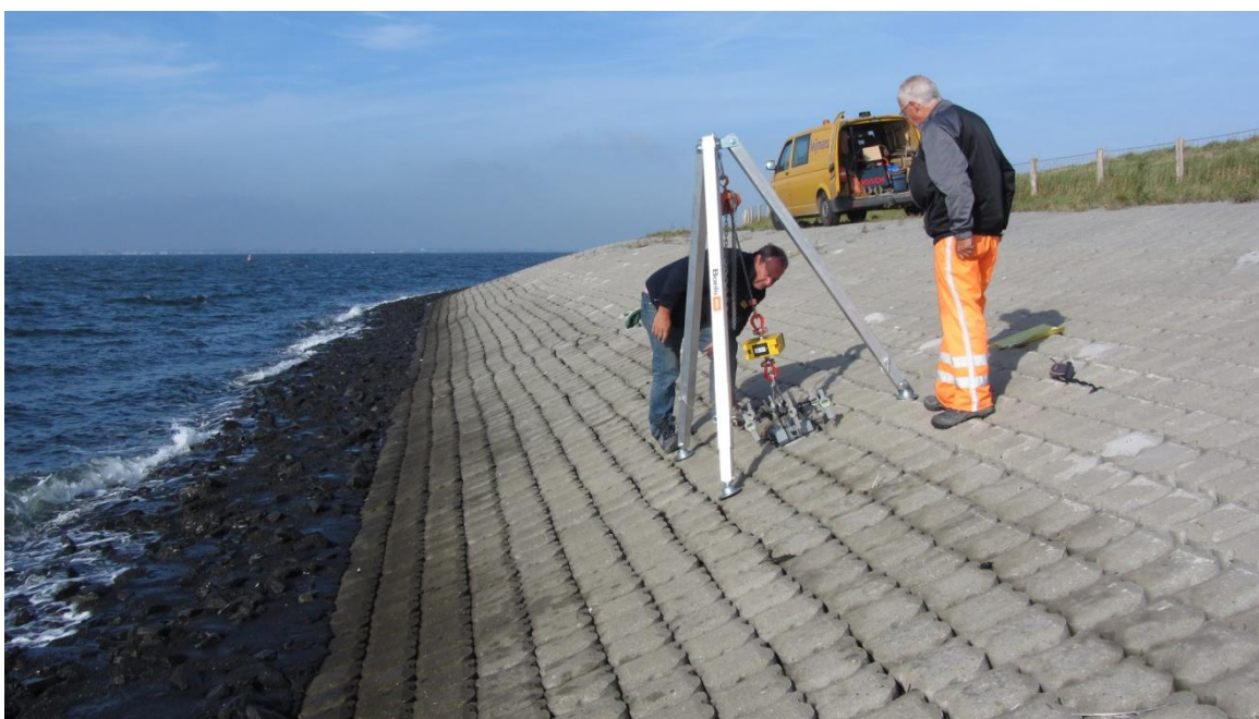
Figuur 1.2 Trekproef op Hydroblocks
