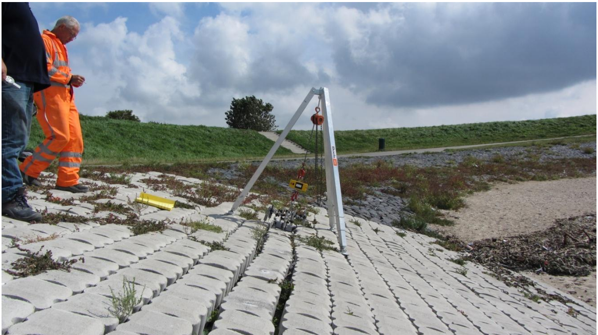
Figuur 2.1 Trekproef op slecht gezette Hydroblocks
