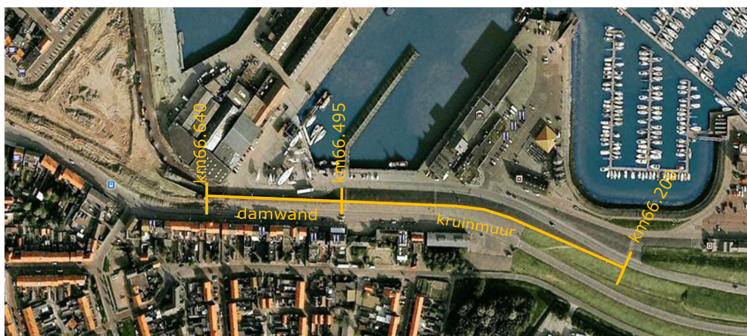
Figuur 1.2 Begrenzing keermuur en damwand
