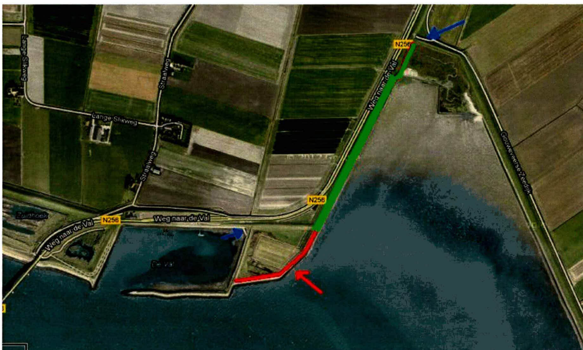
Afbeelding 2: Werkgebied waar de overlaging is voorzien (rood). Het werkgebied wordt betreden vanaf het onderhoudspad (groen) en de toegang is voorzien via de blauwe pijlen.
