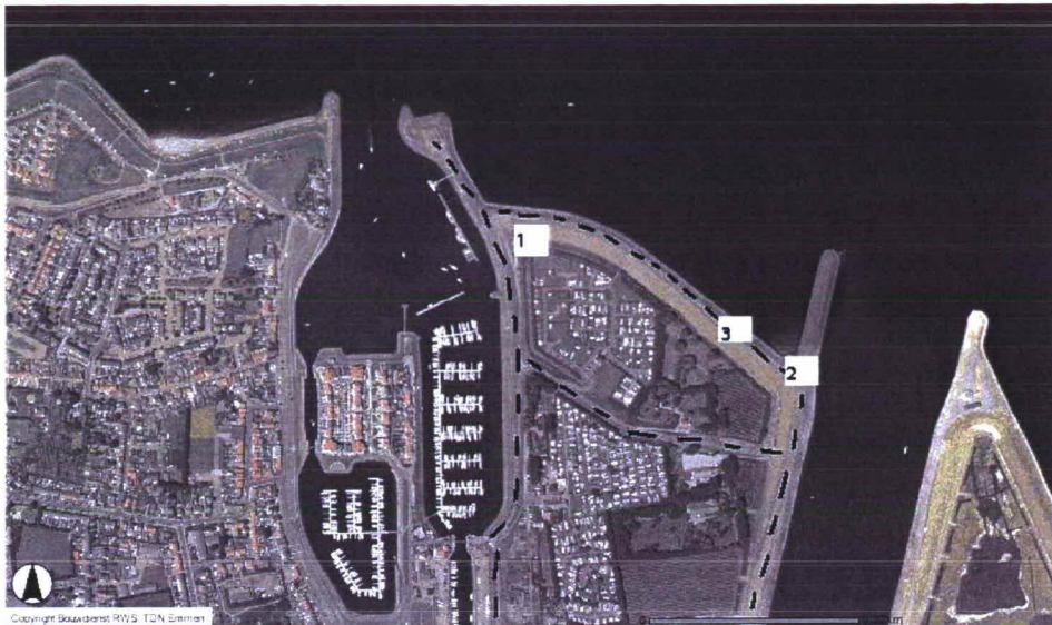
Figuur 2.5 Locaties die mogelijk gebruikt gaan worden voor tijdelijke opslag van kleine hoeveelheden materiaal (1,2,3) en transportroutes (stippellijn) bij de dijkverbetering
