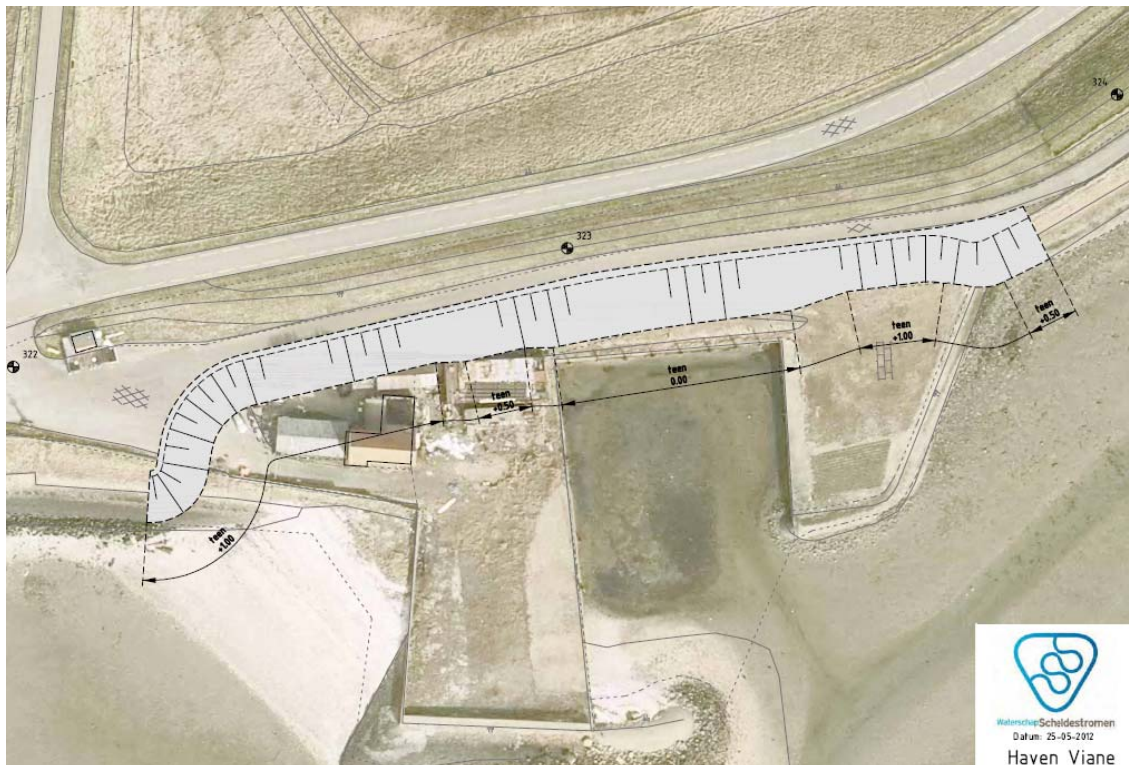
Figuur 2.2: De verborgen glooiing nabij de haven Viane (dp322+50m - dp323+80m).
