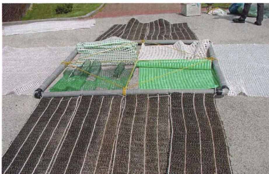
Foto 8 Test opzet voor kolonisatie van verschillende substraattypen (Kusserow en Mählmann). De zwarte substraatmatten onderaan op de foto zijn gebruikt in deze studie (Foto: Mählmann).
