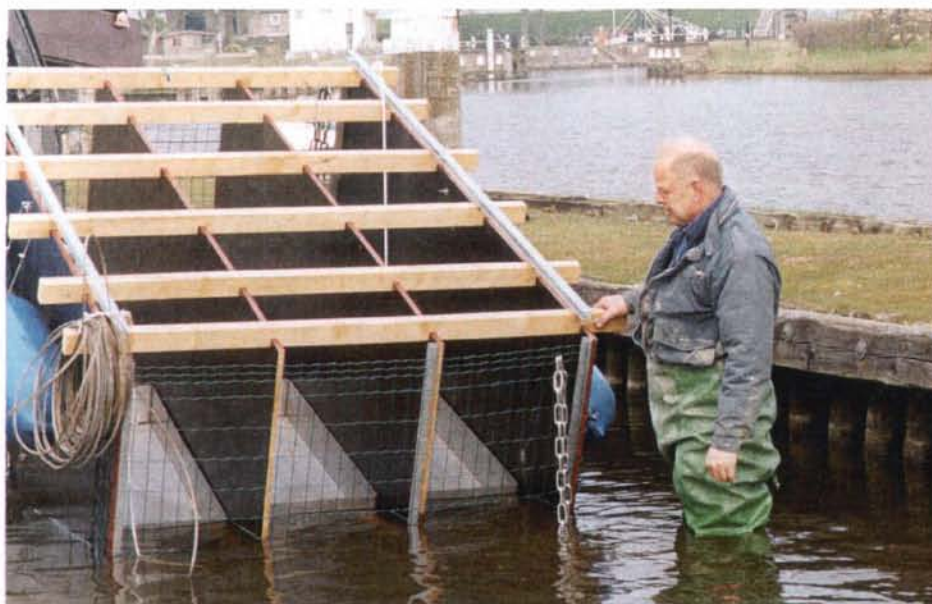
Foto 9 Tewaterlating van de opstelling. Duidelijk zijn de bakken ter opvang van slib in de drie compartimenten en het gaas ter voorkoming van predatie te zien.
