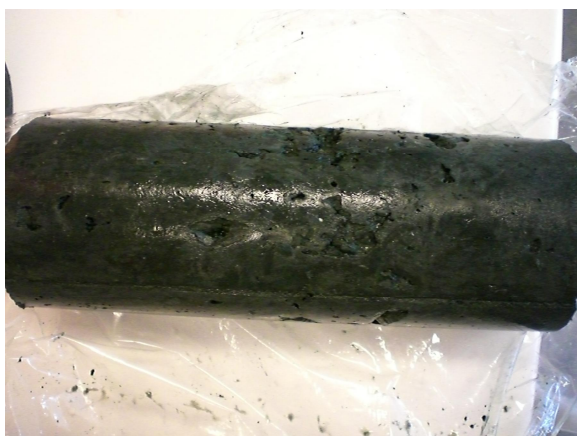
Foto 1: Proefstuk met luchtbellens
