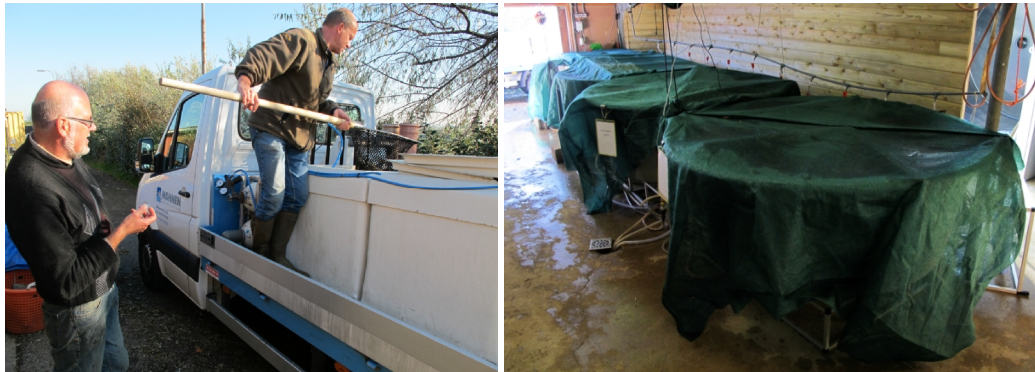
Foto 1 en 2. De levering van de forellen door Mohnen Aquaculture en de vier ronde testbassins van 2 m 3 , waarbij het zoutgehalte instelbaar is met behulp van flowmeters op kraanwater en zeewater.
