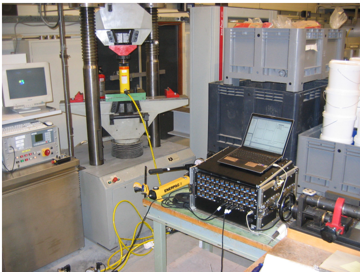
Figuur 33: Opstelling testen druksensoren
