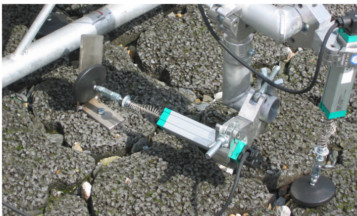
Figuur 42: Meting van vervorming in het vlak van de zetting (XY meting)
