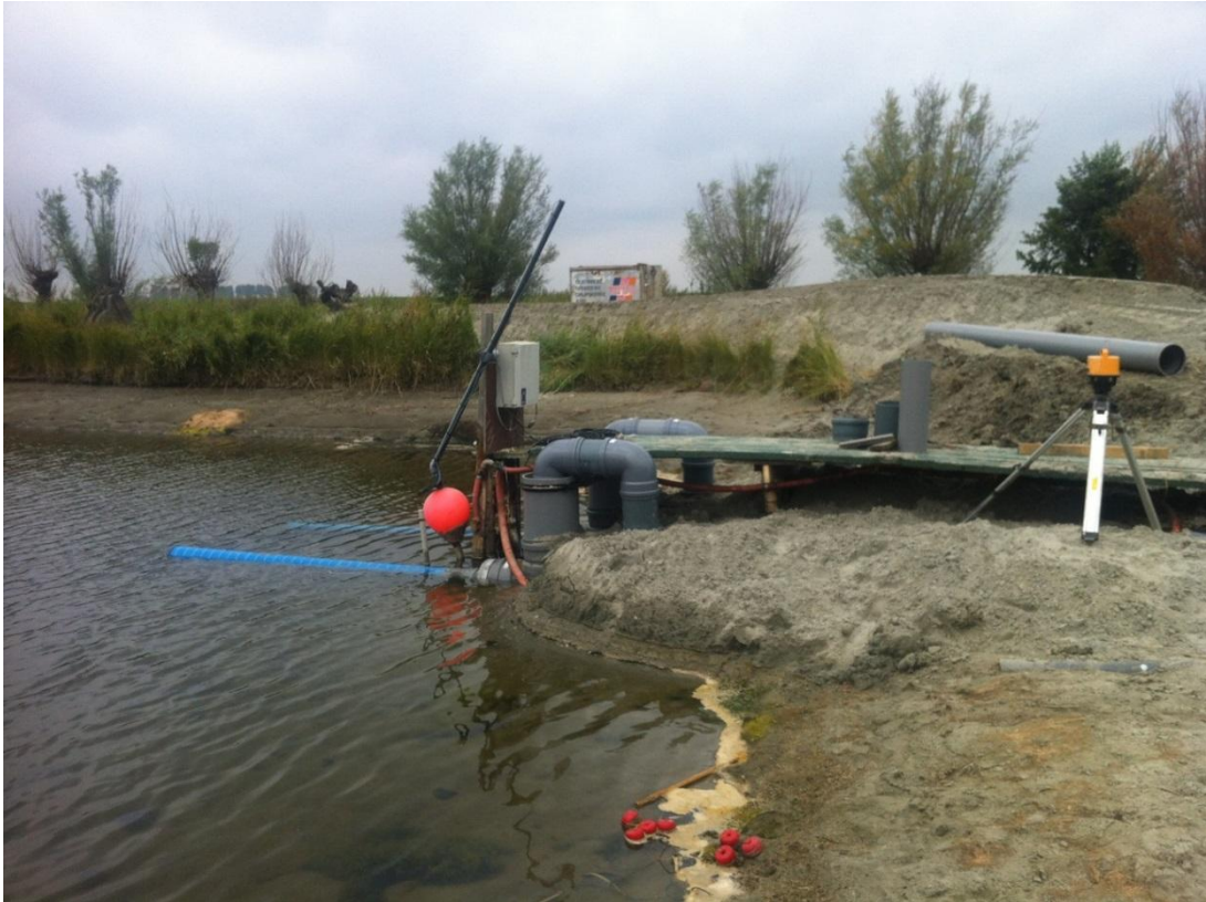
Foto 2. De twee aanzuigleidingen en de pompen die de mossels van zuurstof en algen rijk water voorzien.
