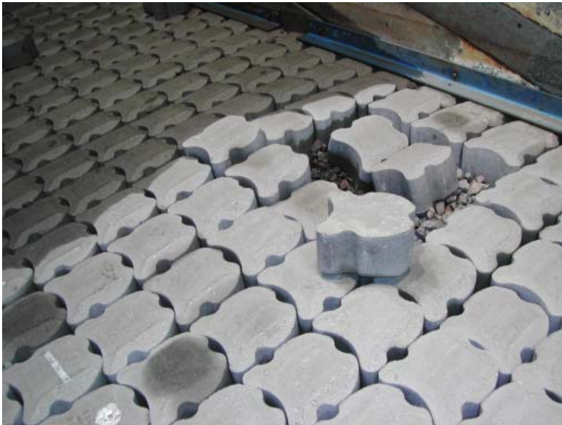
Fig. 3.14 Schade na proef P4252 (zie ook figuur C11) (serie 3)
