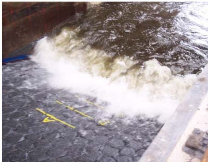
Figuur 3.2 Golfbelasting op Basalton (zie ook figuur C1)
