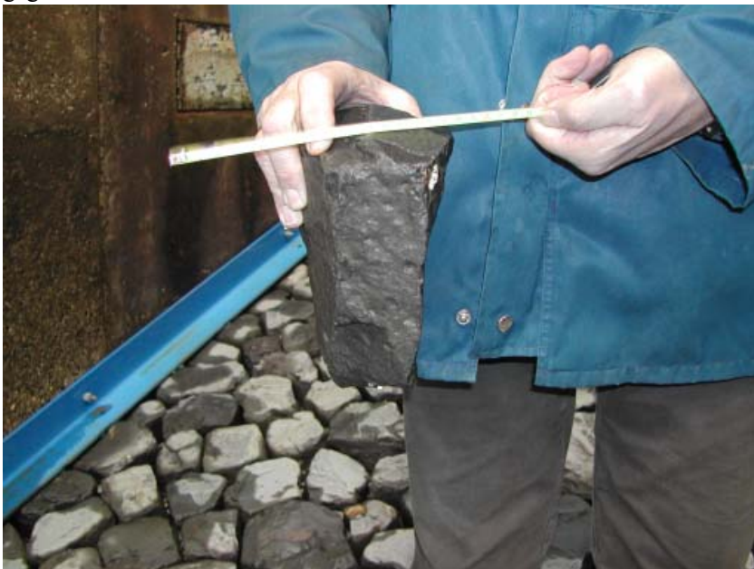
Tapse steen uit proef P4810, die is vervangen
