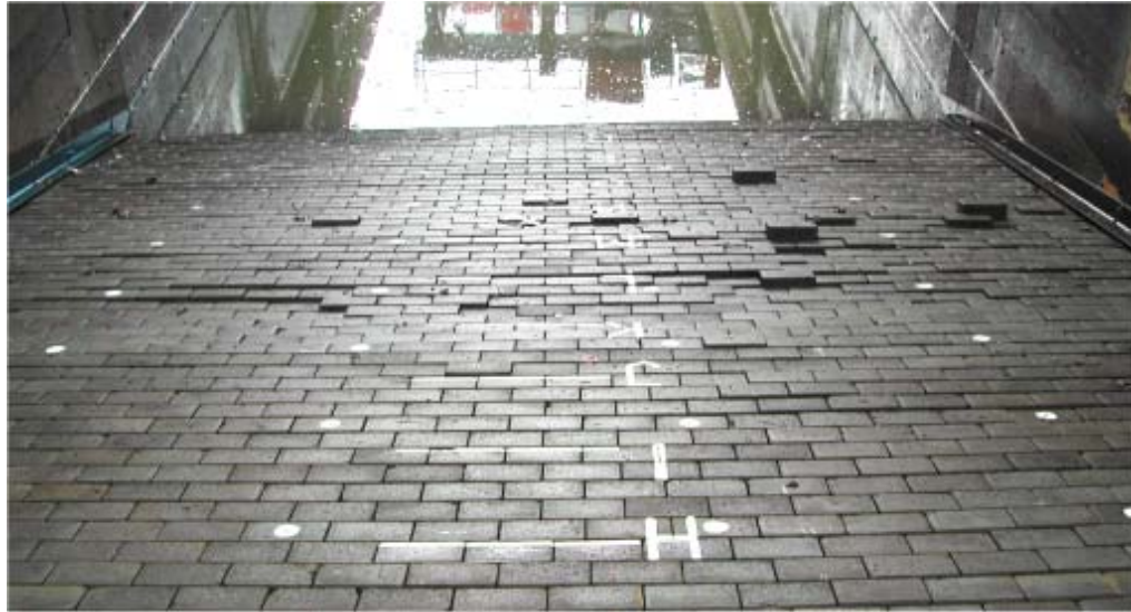
Fig. 3.6 Schade na proef P4120 (zie ook figuur C6) (serie 1)
