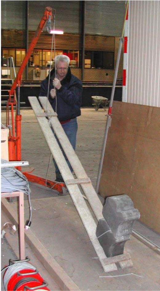
Fig. 3.19 Proefopstelling wrijvingsproeven met de Hydroblocks
