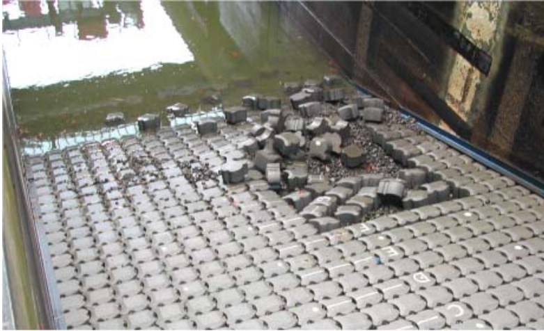
Fig. 3.13 Schade tijdens proef P4251 (zie ook figuur C10) (serie 2)
