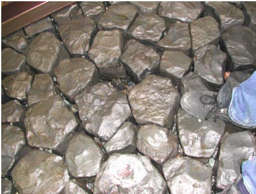
Figuur 3.4 Schade na proef P4812 (zie ook figuur C2 t/m C5) (serie 1) (z = 4,13 m)
