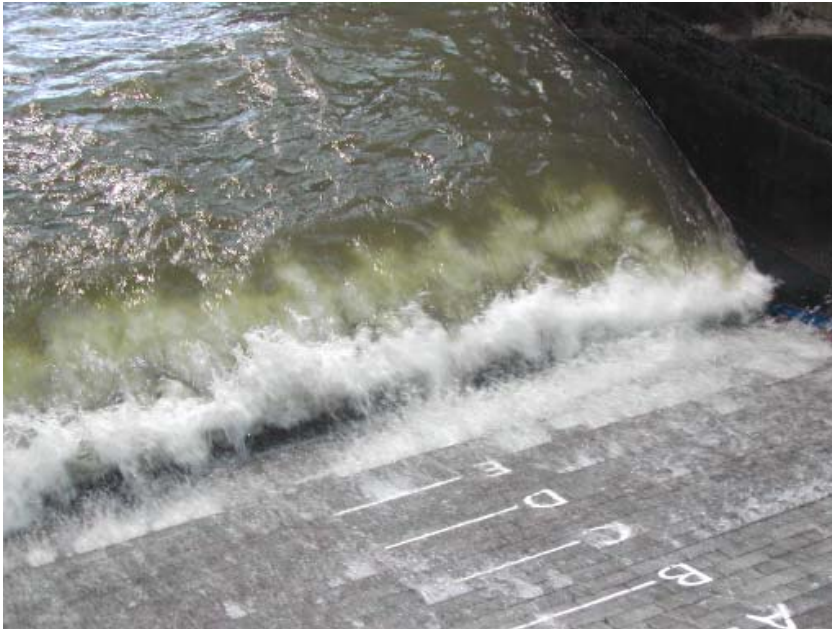
Figuur 3.8 Golfbelasting op blokken op hun kant tijdens proef P4932 (sputters zijn gevolg van golfneerloop tegen opstaande randjes) (zie ook figuur C7) (serie 2)
