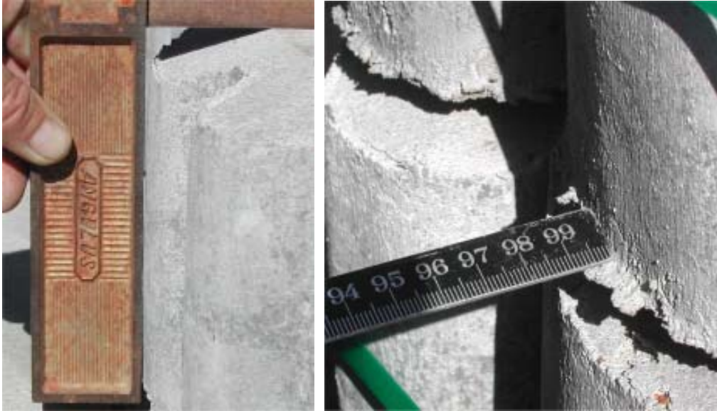
Figuur 3.20, bolling en betonbramen op Hydroblocks
