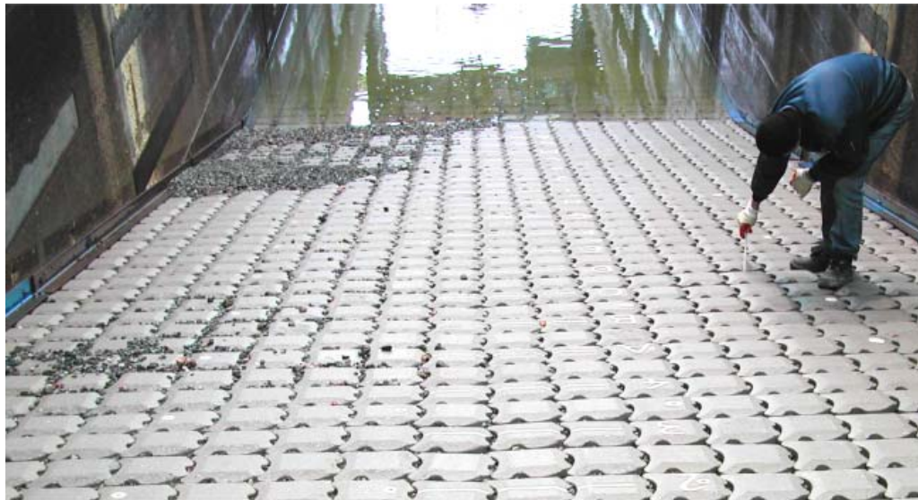
Figuur 4.2, uitspoeling van inwasmateriaal aan halzijde (rechts op de foto), dat zich verzameld aan de meetcabinezijde
