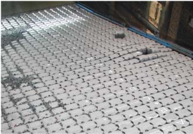
Fig. 3.17 Schade tijdens proef P4257 van serie 5 (zie ook figuur C13)
