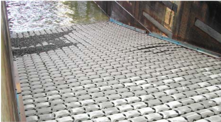
Fig. 3.16 Bolling in talud na proef P4256 (zie ook figuur C13) (serie 5)
