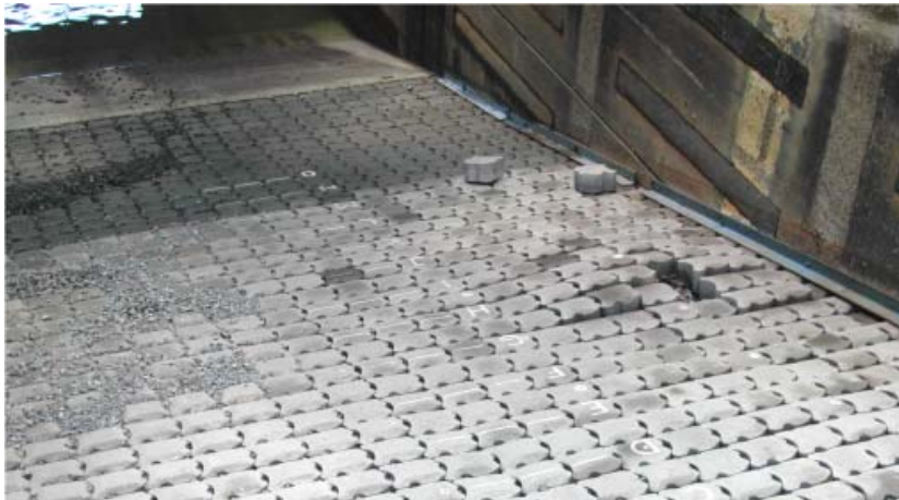
Fig. 3.15 Schade tijdens proef P4253 (zie ook figuur C12) (serie 4)
