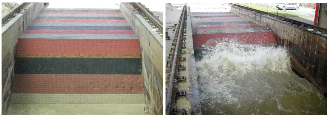
Figuur 5.1, Dunne steenzetting in de Deltagoot, voor de proef en tijdens de golfbelasting
