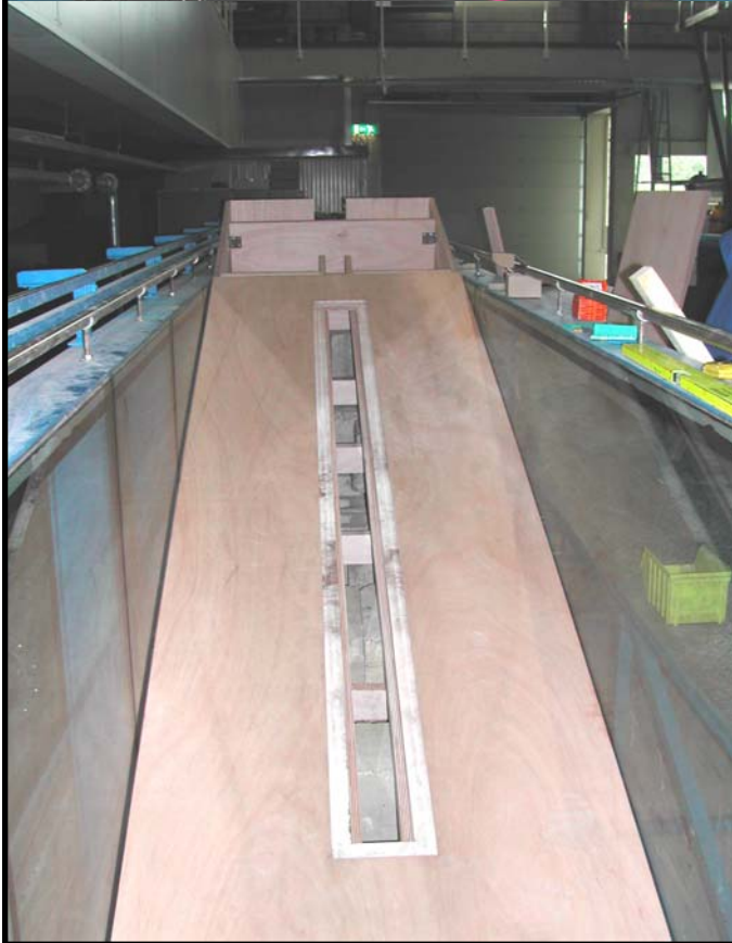
Verzwaren van het 1:3 talud met verstijvingsribben ( boven / vooraanzicht open talud )
