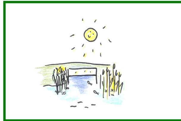
Een ideale vispassage is ruim, heeft een luchtgedeelte en voldoende waterplanten als refugia voor en na de grote oversteek
