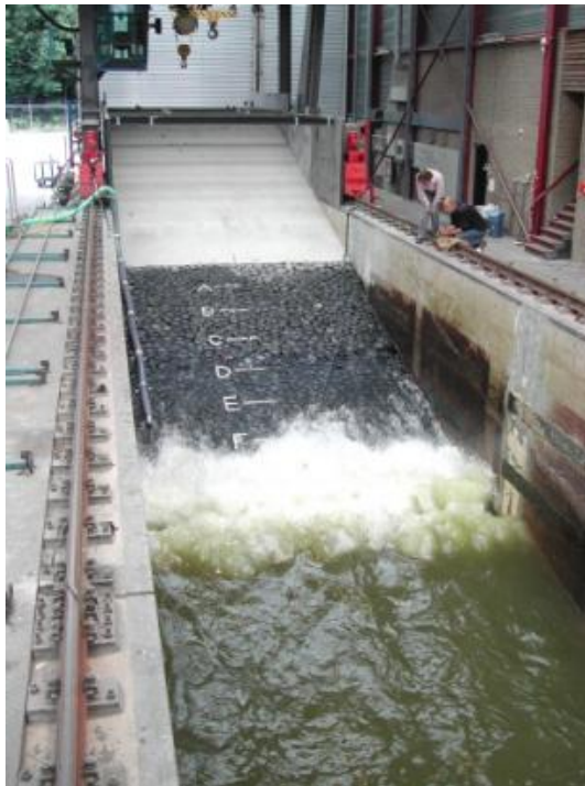
Figuur 1.1, modelopstelling in de Deltagoot tijdens serie 1
