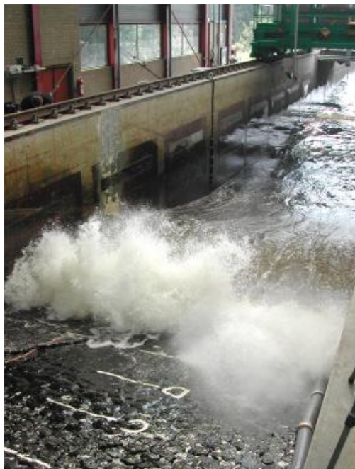
Figuur 4.1, golfaanval op ingegoten bekleding in de Deltagoot tijdens serie 2
