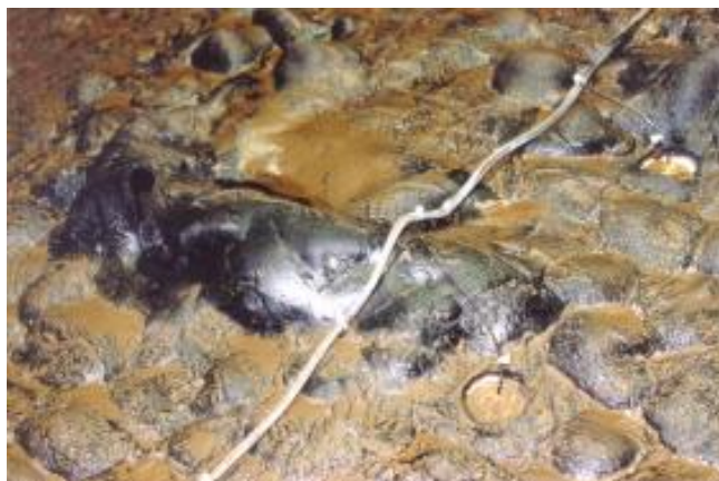
Figuren 2.1, overgieten van basalt in Deltagoot (links) en blaas van de gietasfalt na langdurige golfaanval (rechts)
