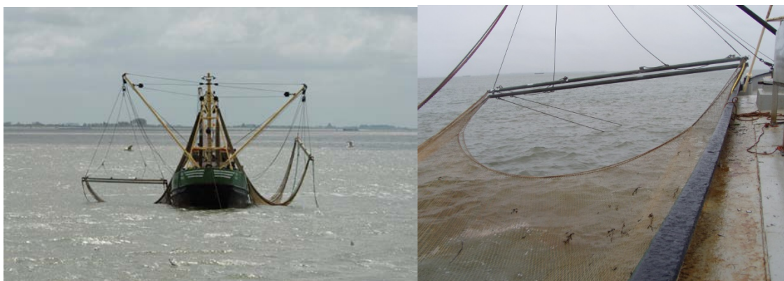
Figuur 3: Ankerkuil schip met twee netten (links) en opgetrokken onderste balk (rechts)
