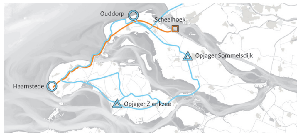
Afb. 12 Lichtblauwe lijnen = drinkwaterleidingen; oranje lijn = ruwwaterleiding
