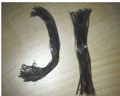
Figuur 4. Monsters van gebruikt (links) en nieuw ongebruikt (rechts) mosseltouw na chemische reiniging.
