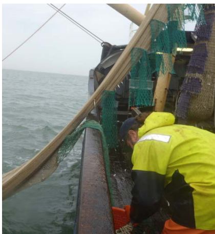
Figuur 2. Groene plastic- en paarse nylon slijtmatten aan de visnetten op een garnalenketter (Bron IMARES Yerseke).
