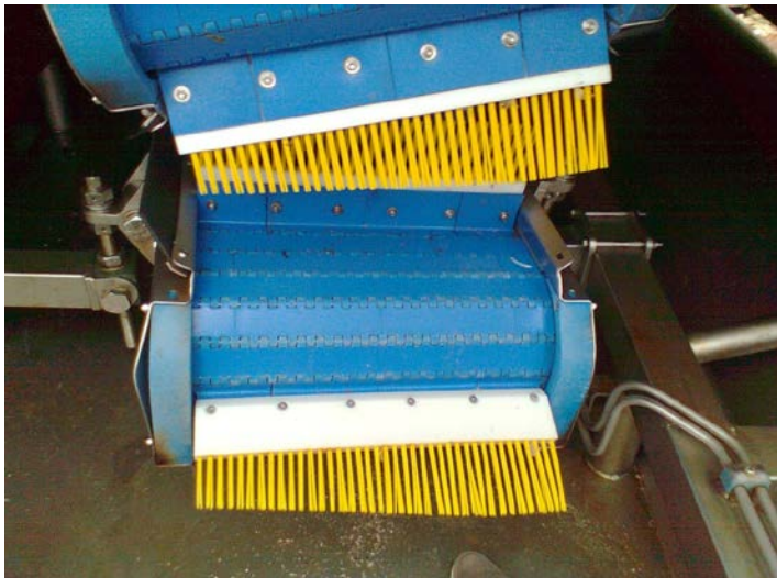
Figuur 8. Borstels van de YE82 (Slaak B.V.) op twee tegenover elkaar liggende lopende banden. De blauwe lopende banden bewegen van rechts naar links zodat de korte borstels het eerst de mosselen raken.
