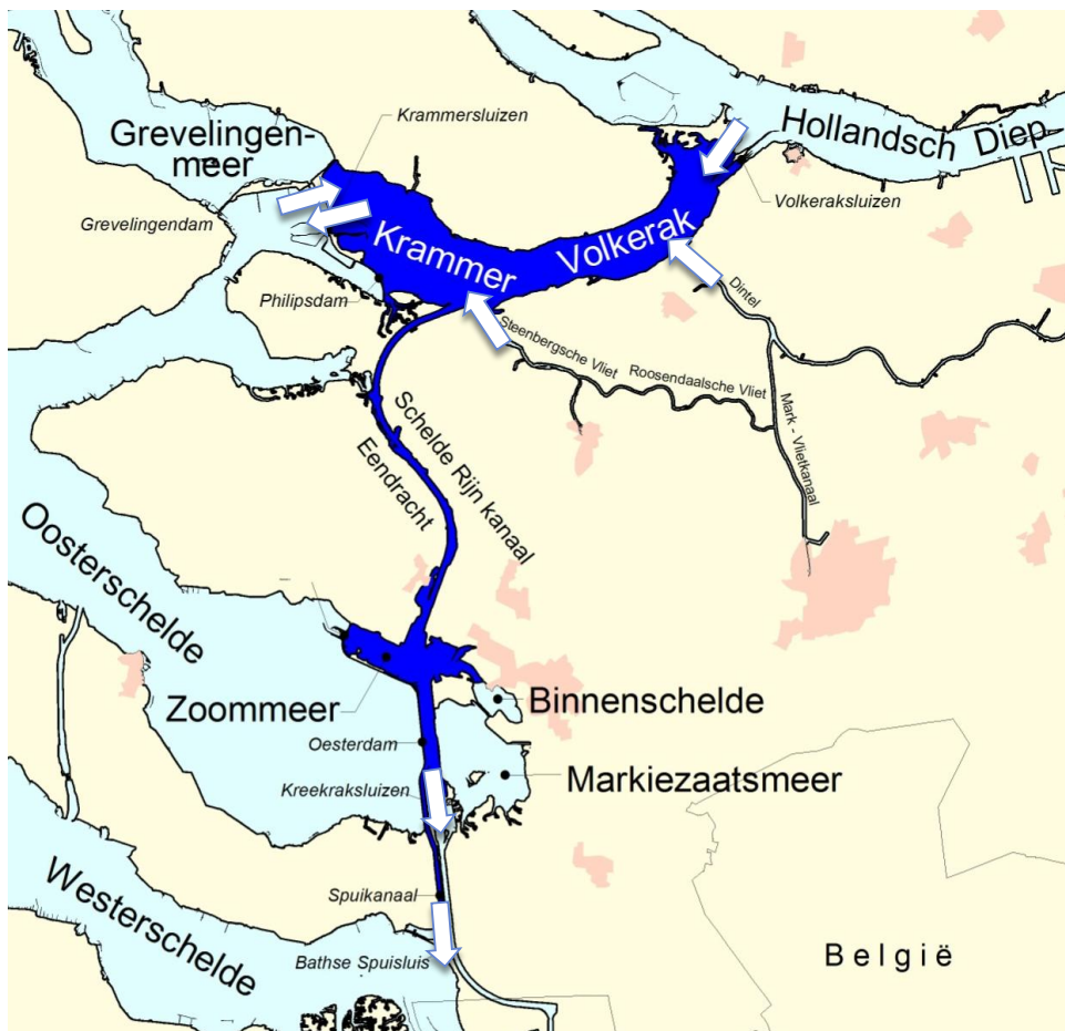
Figuur 4: Schematische weergave van het Volkerak-Zoommeer met de aan- en afvoer van water bij projectalternatief A
