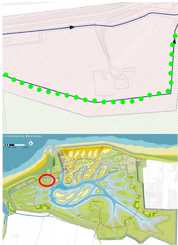
Figuur 6.2 Ontwatering via hoofdwatgang rondom het perceel Walendijk 4. De groen gemarkeerde watgang wordt nieuw gegraven. (Traject N1)
