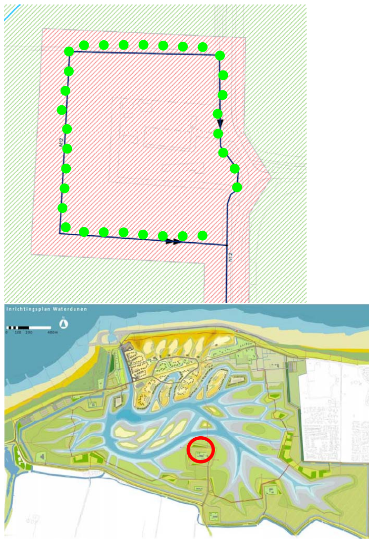
Figuur 6.1 Ontwateringsloot rondom het perceel Slikkenburgseweg 5. De groen gemarkeerde watergang wordt nieuw gegraven. (Traject N12)
