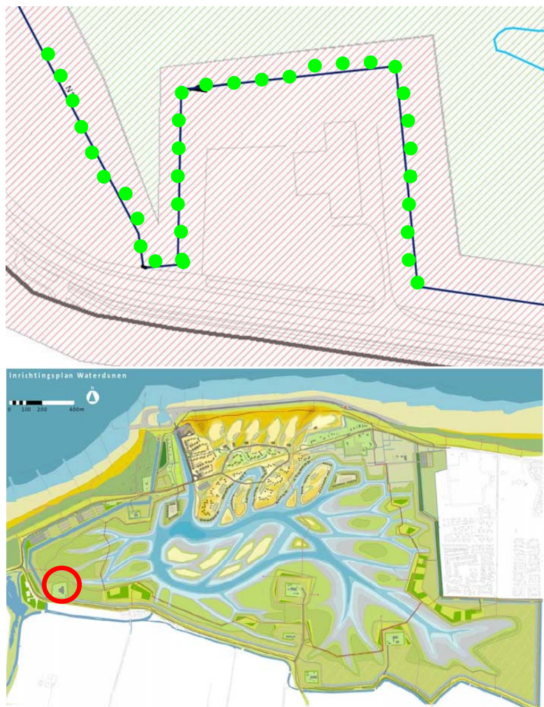
Figuur 6.8 Locatie Puijendijk 1, dat is omringd door het afwateringstraject N9. De groen gemarkeerde watergang wordt nieuw gegraven.
