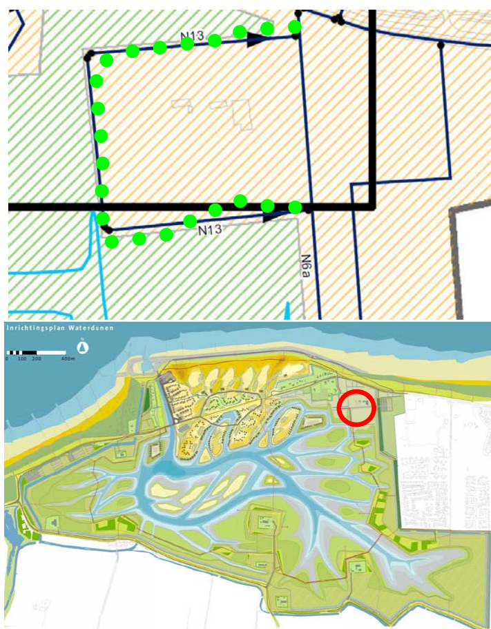
Figuur 6.3 Ontwateringsloot rondom het perceel Nieuwesluisweg 11. De groen gemarkeerde watergang wordt nieuw gegraven. (Traject N13)
