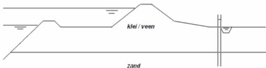
Figuur 6.5: Basis schematisering situatie zonder geul (dijkvak 2)
