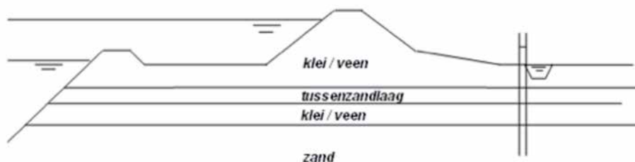
Figuur 6.4: Basis schematisering situatie met geul (dijkvak 1)
