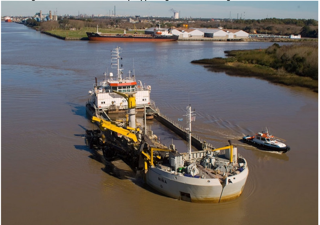
afbeelding 2.5. Voorbeeld van een sleephopperzuiger met laadvermogen 5.000 ton
