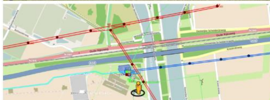
Figuur 10: De huidige situatie van het hoofddeelstation Rilland, met op de voorgrond 20 kV middenspanningslijn die het decentraal opgewekte energie, afkomstig van het nabij gelegen windpark, naar het HS-net transporteert. In het midden wordt de 150 kV net vanaf de grond opgehangen en op het net verder gedistribueerd. Langs het hoofddeelstation loopt de 380 kV interconnectie hoogspanningslijn naar België
