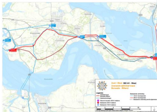
Figuur 9: 380 kV en 150 kV hoogspanningslijnen en hoofddeelstations in de bestaande en toekomstige (Anon. 2014)]
