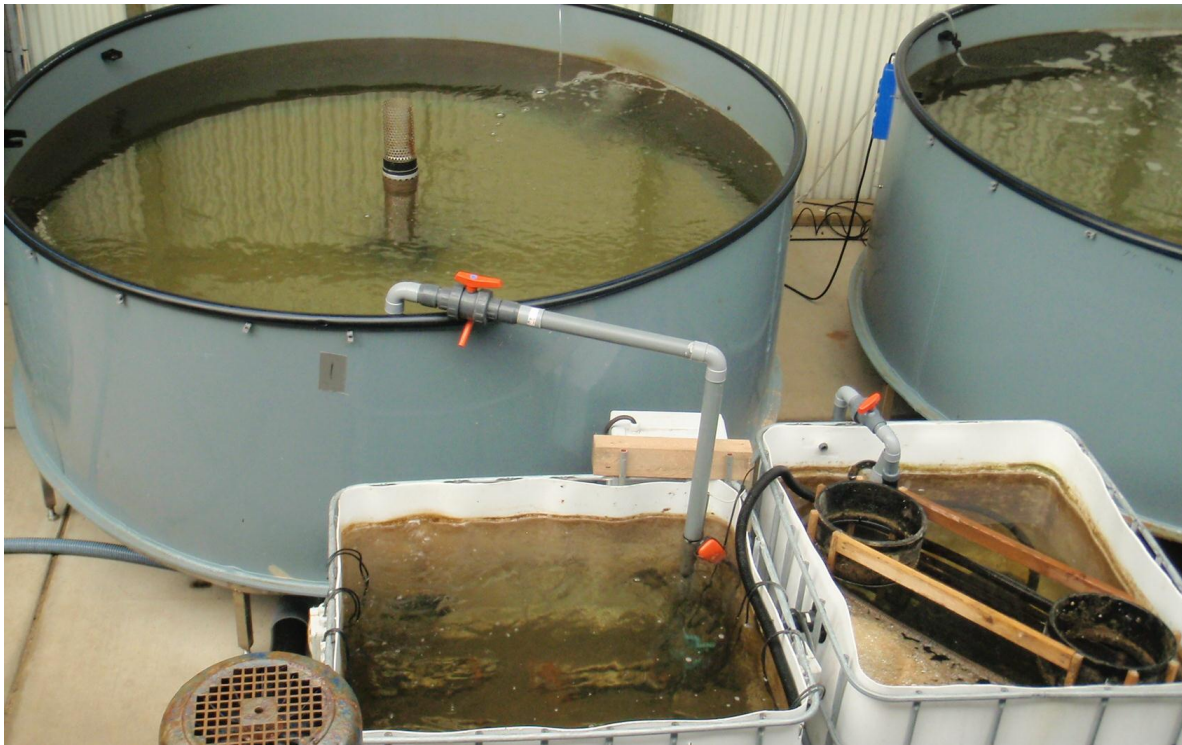
Fig. 14. 20 °C tank met verwarmingsbuffer en warmte wisselaar voor verversing.
