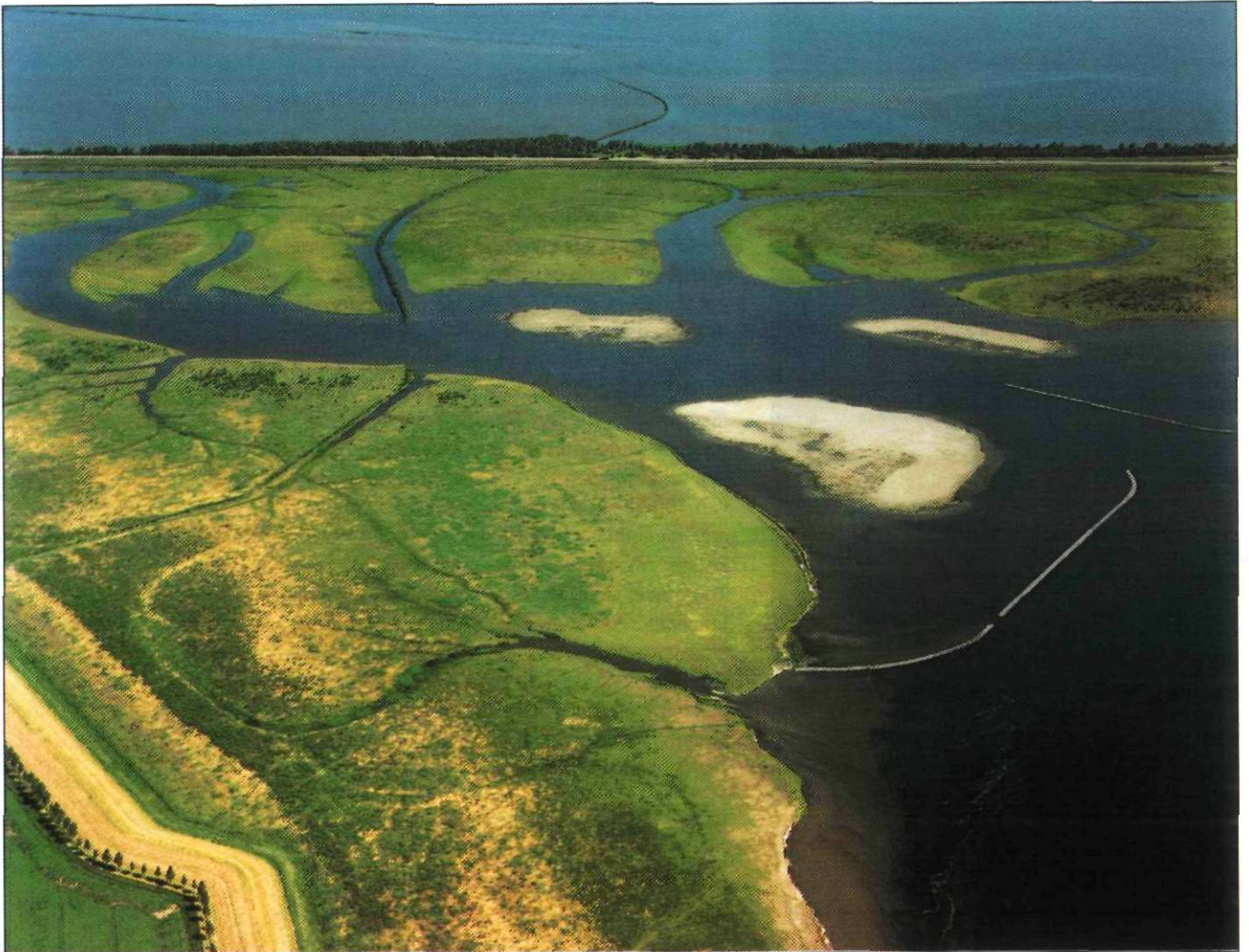
Foto 11. Hellegatsplaten met de aangelegde eilandjes en vooroeverdedigingen.
