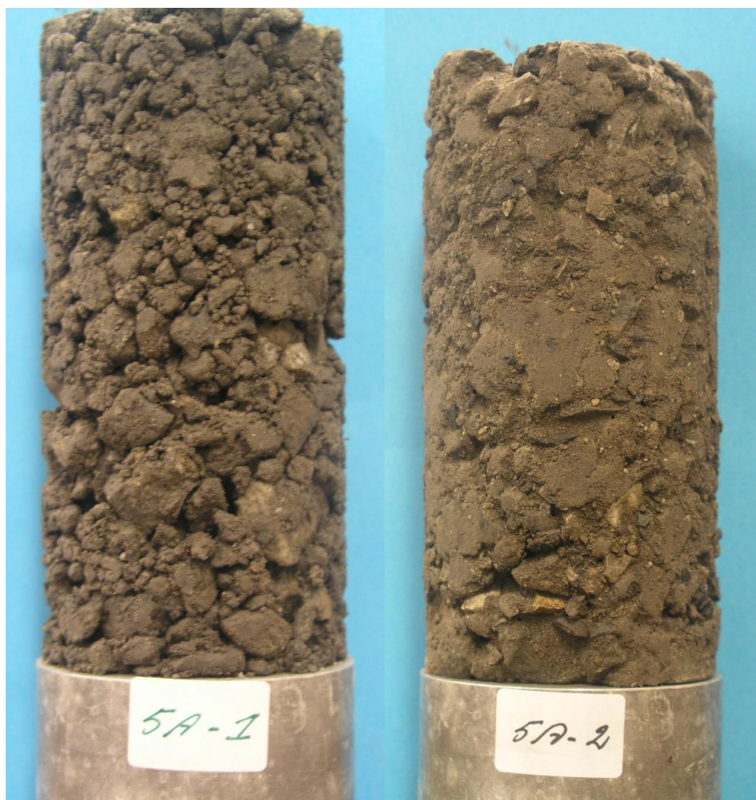
Figuur A.2 Locatie 2: Mijnssteen (5A-1, losse pakking: 3 \cdot 10^{-5} m/s; 5A-2, goed verdicht: 7 \cdot 10^{-6} m/s)
