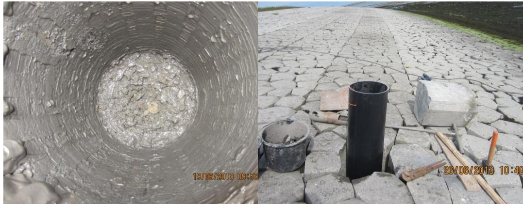
Figuur 3.11 Slurry op wanden boorgat en deel van de bodem (links); Plastic pijp op bodem van boorgat geplaatst ter voorbereiding op de falling head test (rechts)
