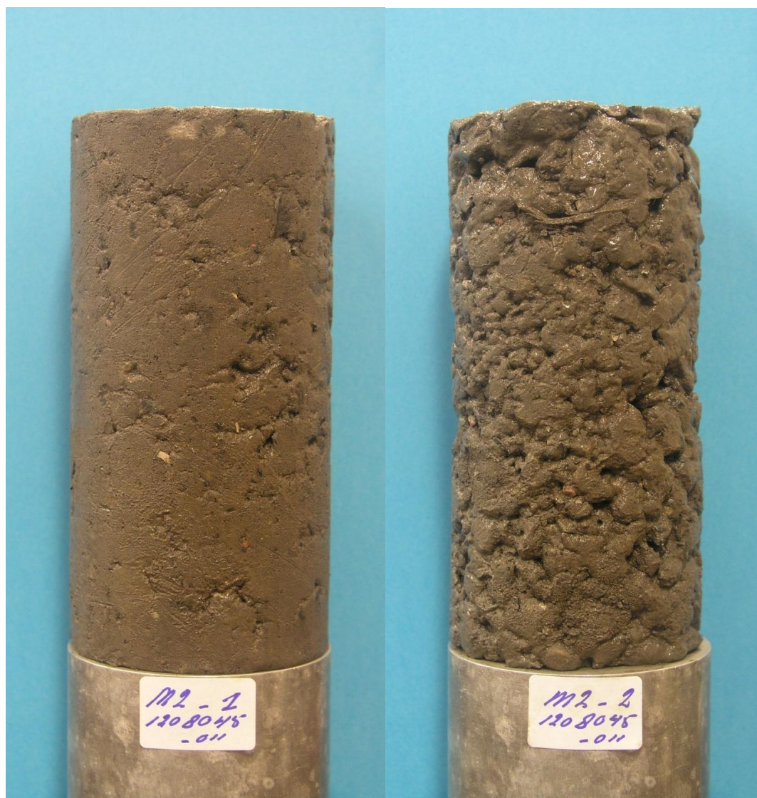
Figuur A.1 Locatie 1: Mijnsteen (M2-1, optimaal verdicht: 3 \cdot 10^{-10} m/s; M2-2, losse pakking: 1 \cdot 10^{-5} m/s)
