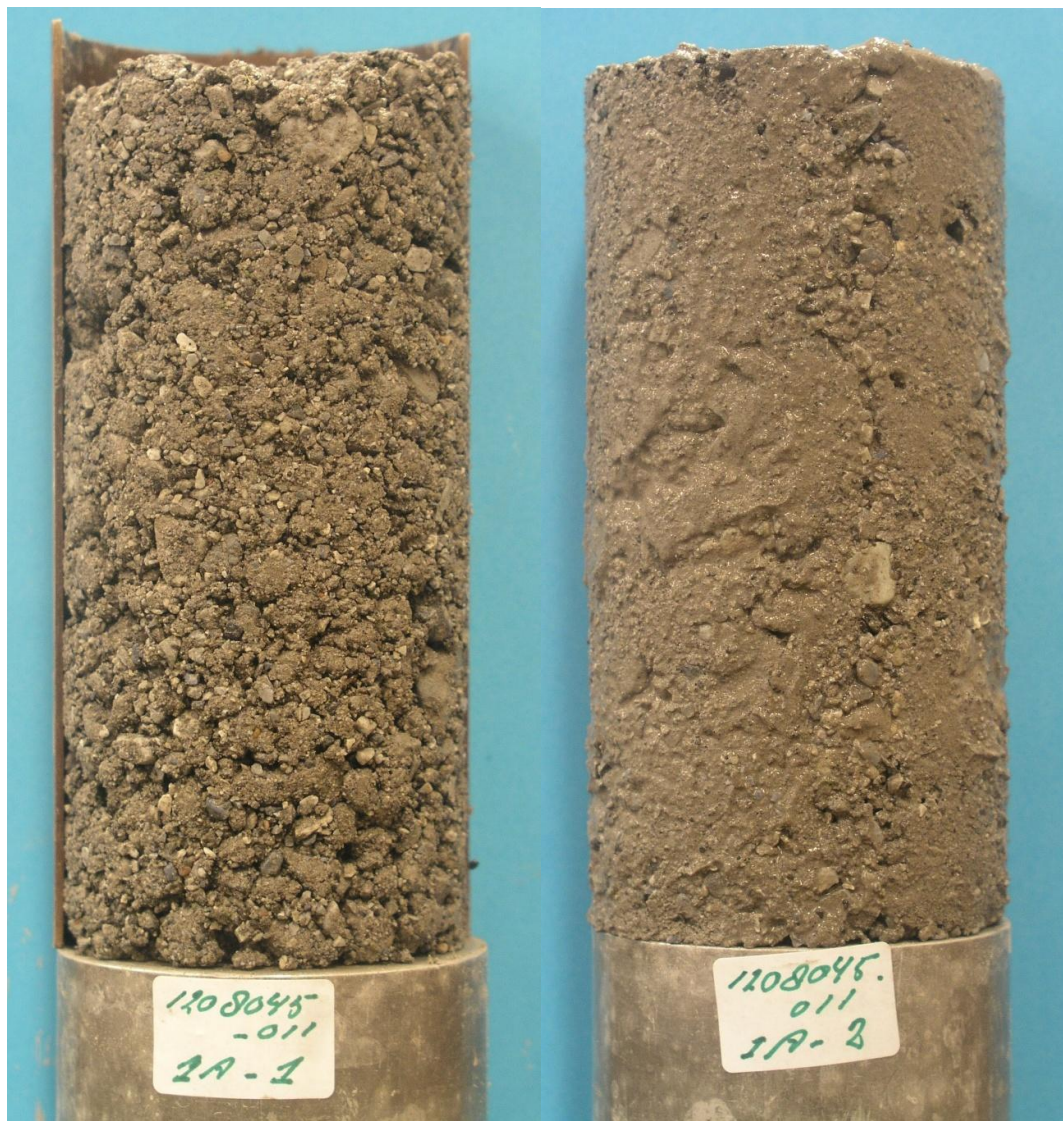
Figuur A.4 Locatie 4: Slak (1A-1, losse pakking: 2 \cdot 10^{-6} m/s; 1A-2, dichte pakking: 4 \cdot 10^{-7} m/s)
