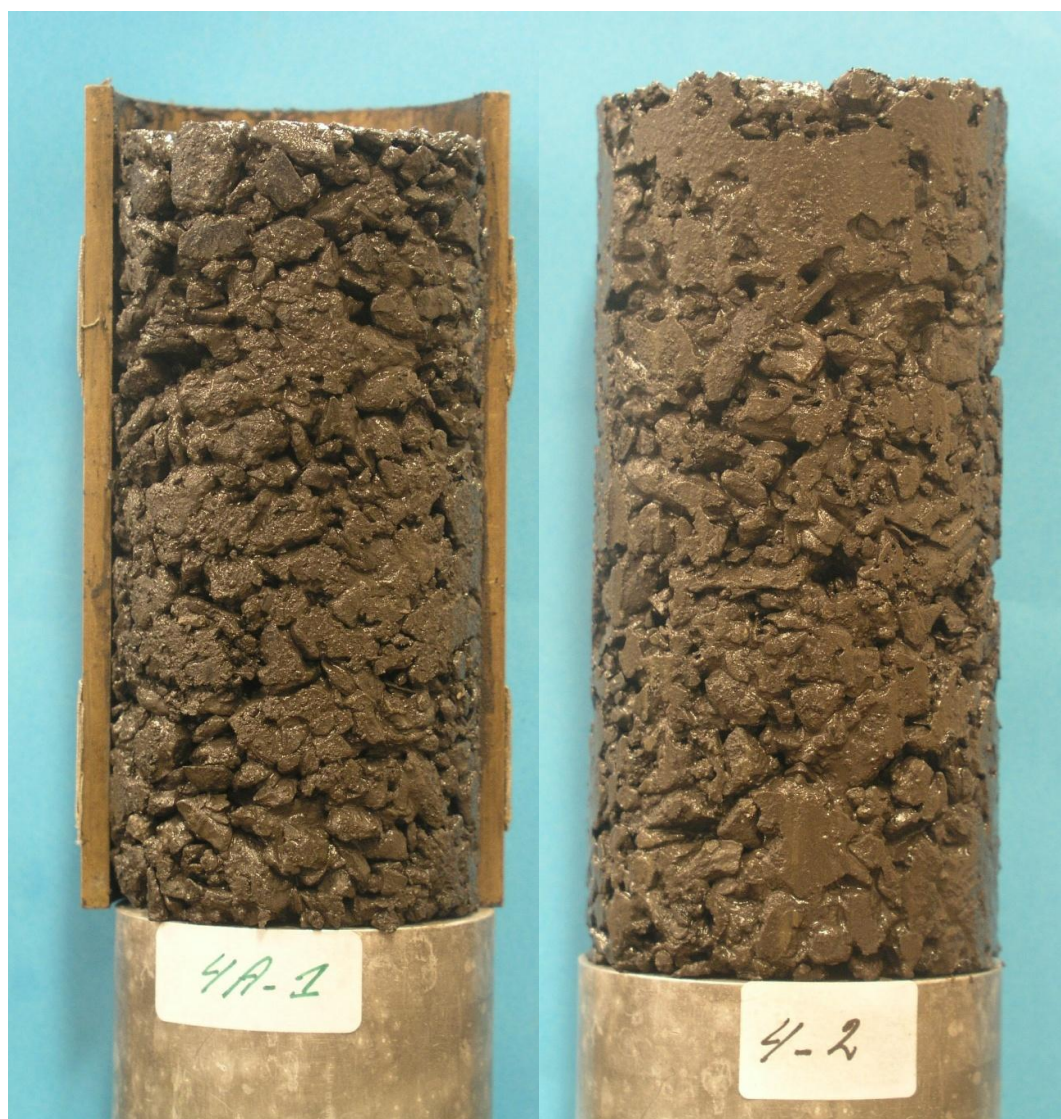
Figuur A.5 Locatie 5: Mijnsteen onsamenvastend (4A-1, losse pakking: 3 \cdot 10^{-5} ; 4A-2, goed verdicht: 5 \cdot 10^{-6} )
