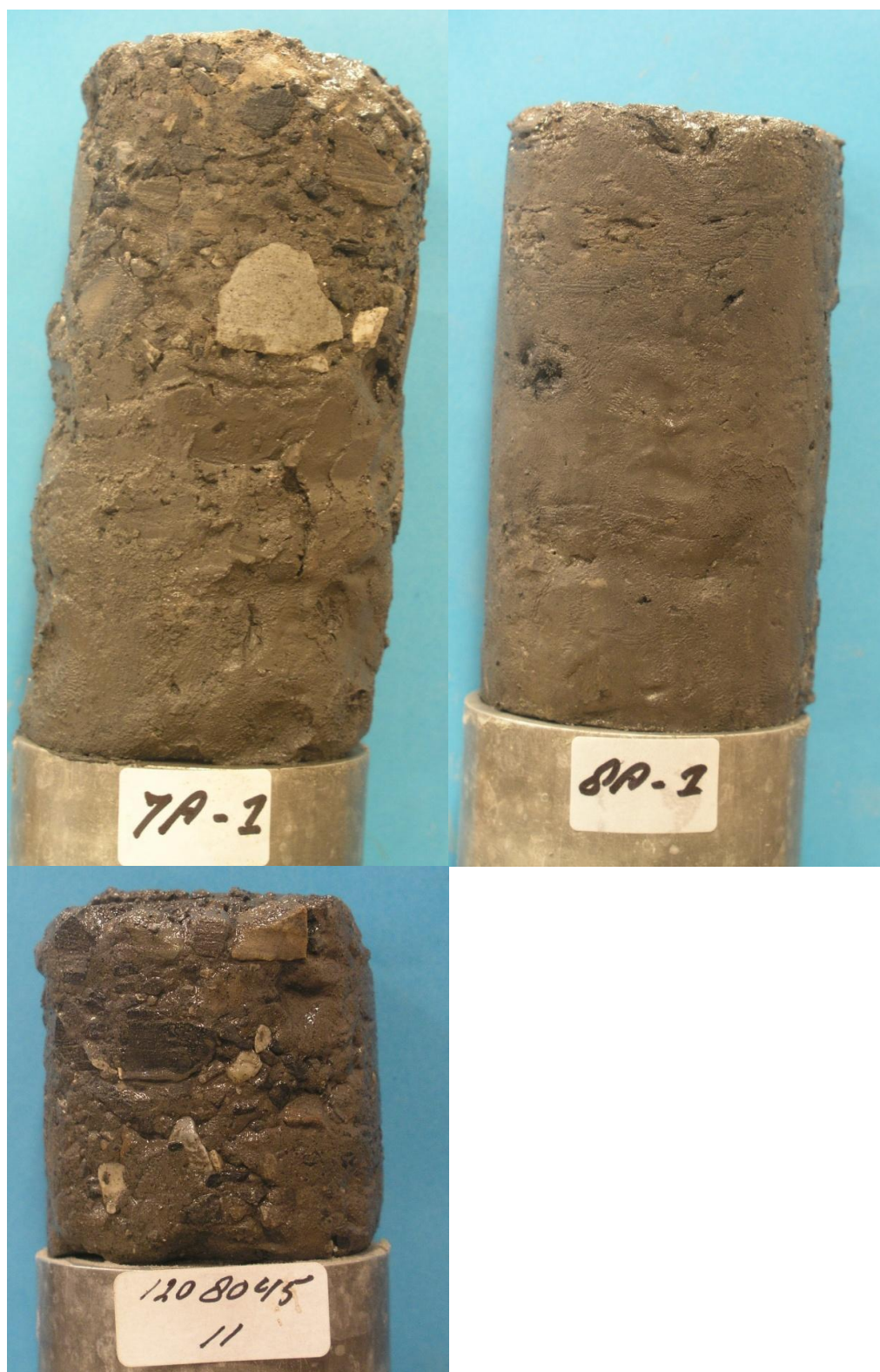
Figuur A.3 Locatie 3: Mijnsteen, 3 maal "ongeroerde" monsters van verschillende dieptes ( 1 \cdot 10^{-9} m/s; 1 \cdot 10^{-9} m/s; 3 \cdot 10^{-8} m/s)
