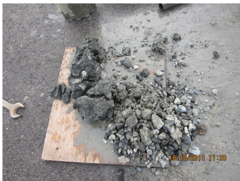
Figuur 4.17 Inhoud van de boorhuls uitgelegd op een plank, merk op dat de slak in losse korrels uiteen is gevallen door het boren; in het siltige deel van het monster, links achter, zijn nog enkele korrels slak zichtbaar
