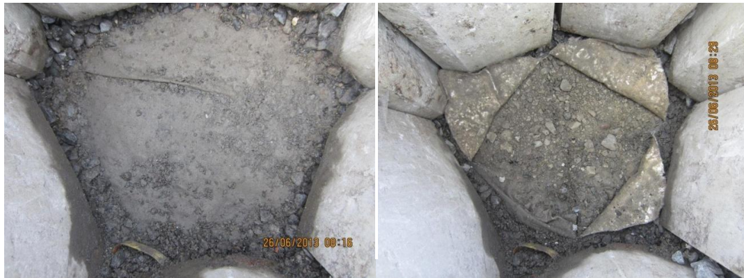
Figuur 3.7 Links: filtermateriaal weggegraven tot op het geotextiel; rechts: geotextiel kruisgewijs vanuit het midden ingesneden en opengelapt zodat de onderlaag kan worden onderzocht
