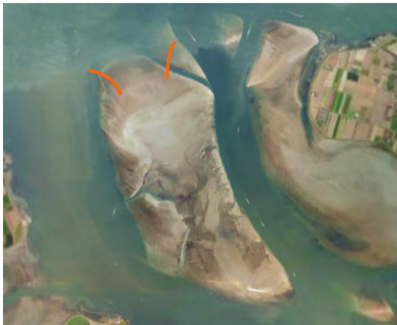
Figuur 8.1 Voorbeeld van plaat suppletie die de natuurlijke plaatopbouw versterkt.
