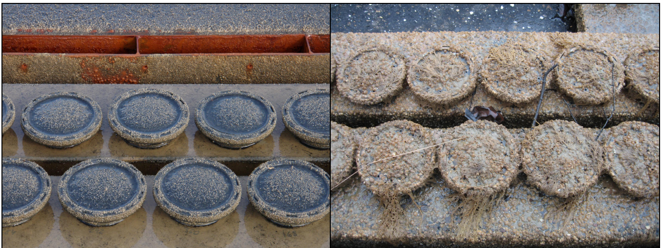
Figuur 5.3 Detailopname van de diffusoren na 1,5 maand gebruik (links) en aan het eind van de duurproef na 8 maanden gebruik (rechts). Na 1,5 maand bestond de aangroei voornamelijk uit zeepokken. Na 8 maanden hadden zich ook algen en wieren gevestigd.
