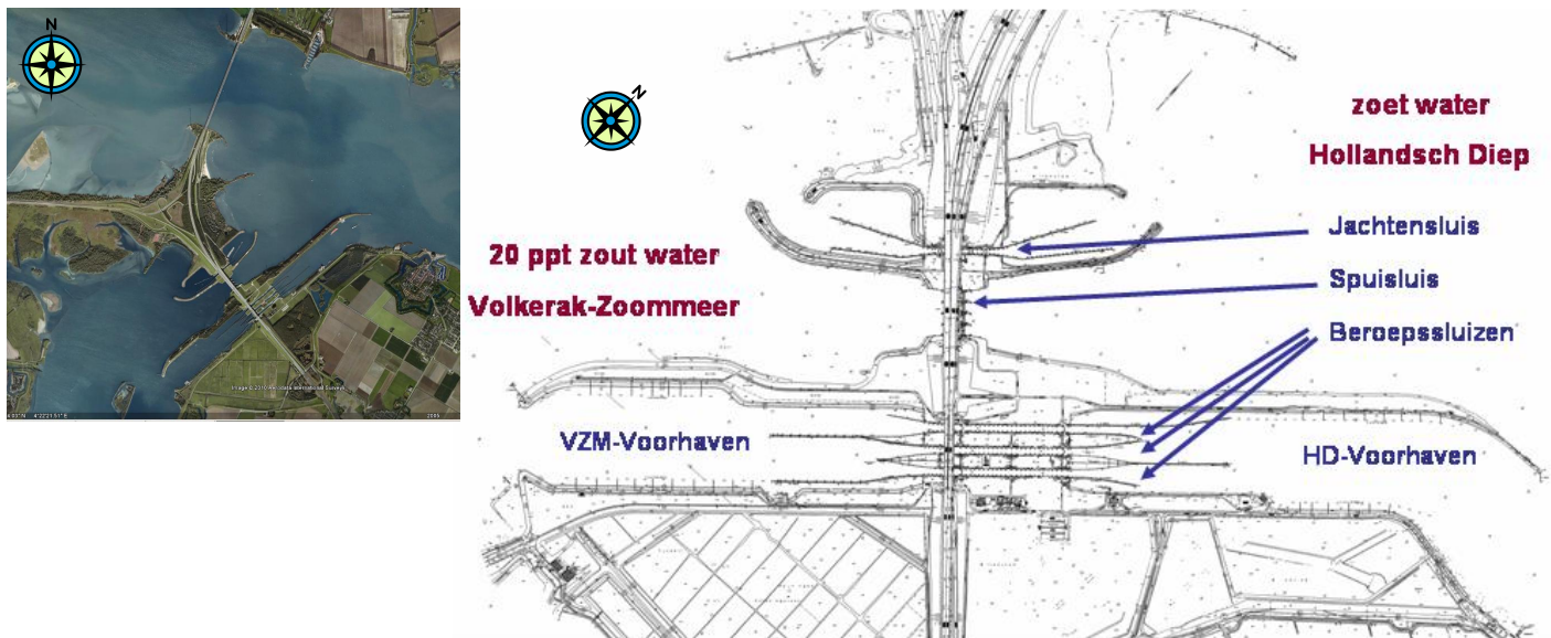
Figuur 2.3 Het Volkeraksluizencomplex (anno 2010) dat het Volkerak-Zoommeer voor scheepvaart verbindt met het Hollandsch Diep via drie beroepssluisen en een jachtensluis, alle met voorhavens, en daartussen de spuisluis.
