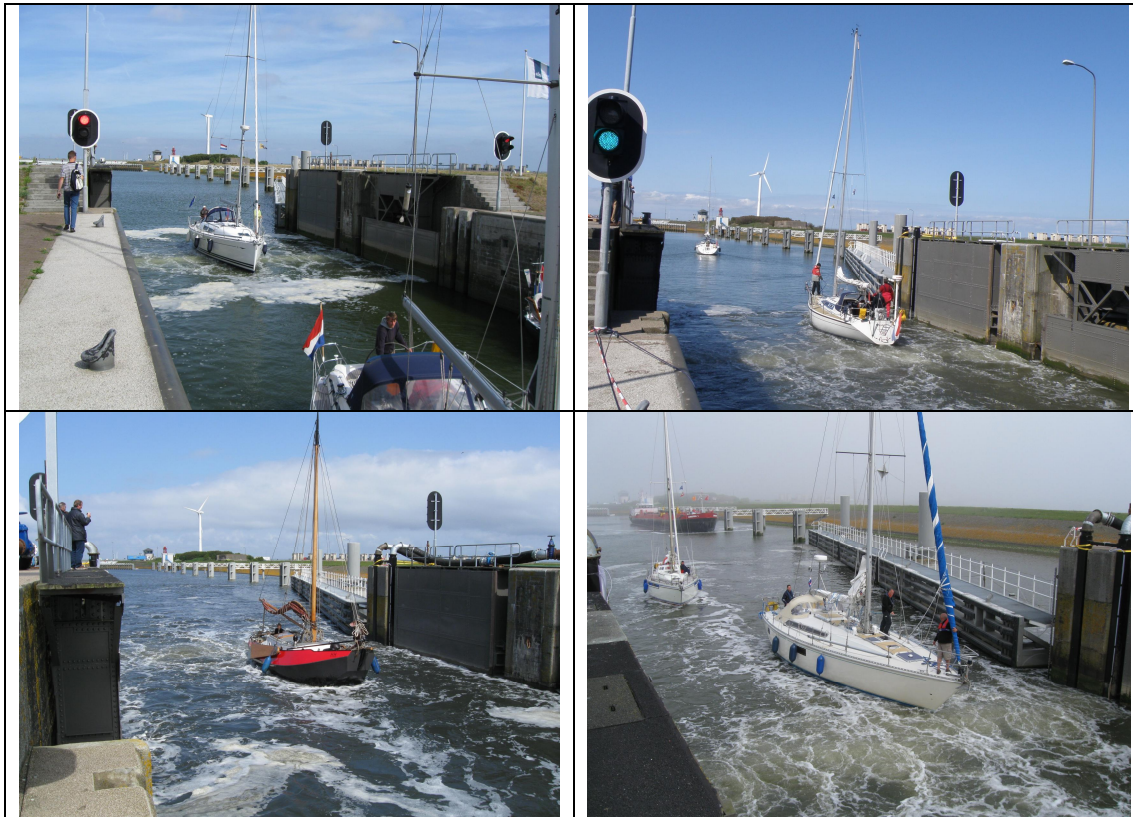
Figuur 5.1 Passage luchtbellenscherm door recreatievaart tijdens de Praktijkproef in de Stevinsluis (boven: traditionele bellenscherm; onder: Innovatieve bellenscherm plus waterscherm). Geconcludeerd is dat het passeren van een bellenscherm geen probleem is voor recreatievaart.
