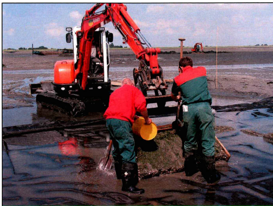
Figuur 11 Lossen van een plag in een plot met net
