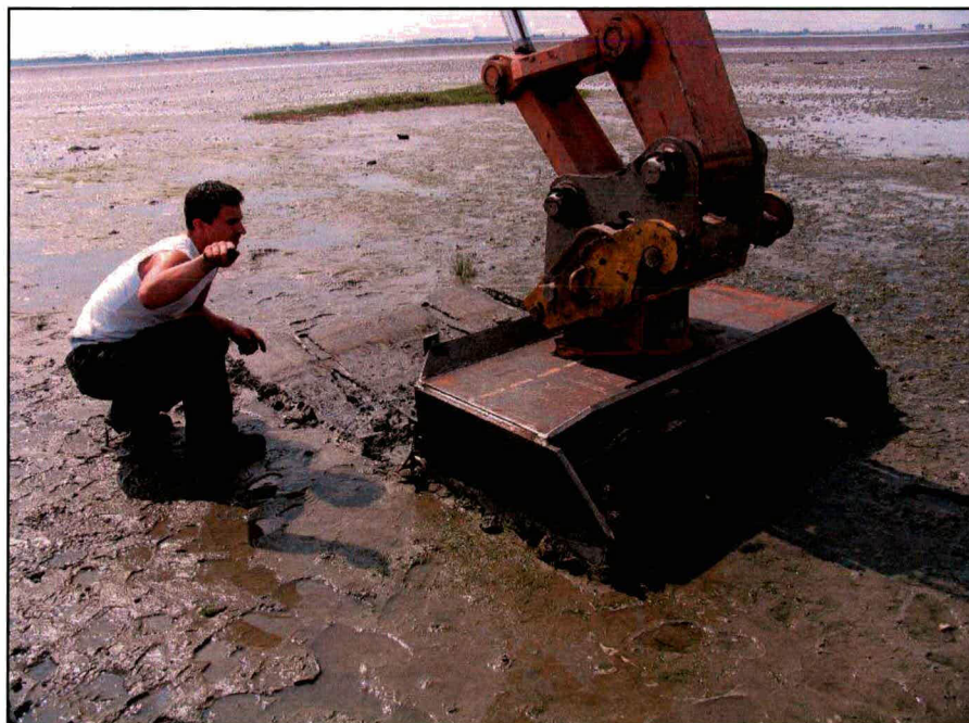
Figuur 6 Plaggenrooier in werking op donorlocatie
