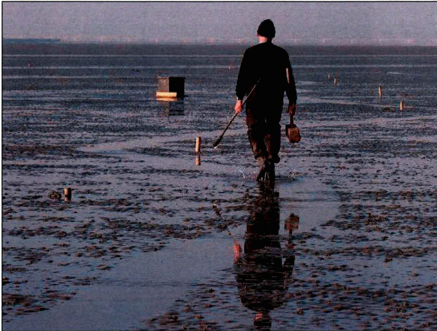
Figuur 13 Piketpalen worden aangebracht op hoekpunten van de plots
