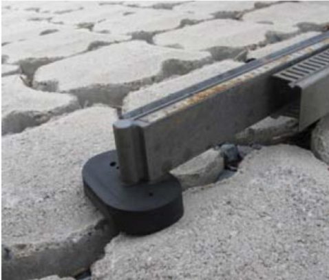
Figuur 4.2 Brede rubbervoet als steunpunt voor de geofoonbalk op de steenzetting
