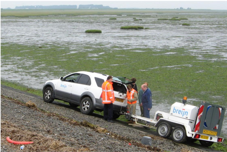
Figuur 1.2 Voertuig met aanhangwagen met apparatuur voor VGD-metingen
