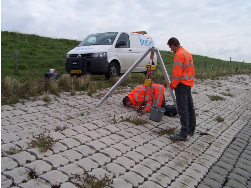
Figuur 4.4 Uitvoering van trekproef met driepoot, digitale unster en takel
