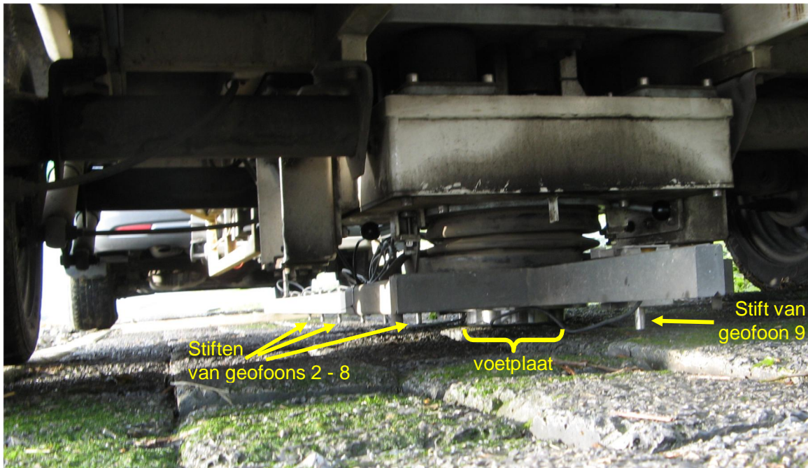
Figuur 1.3 Vanaf de achterzijde zijn onder de aanhangwagen de voetplaat van het valgewicht en de stiften van de gefoons te zien
