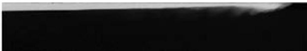
Figuur 5.3 Dichtheidsstroming bij een lock-exchange stroming over een gedeelte van de waterdiepte. De lichte vloeistof stroomt van links naar rechts in de toplaag, uit Shin et al, (2004) figuur 18. De laagdikte neemt af naar de tip van de zoetong.
