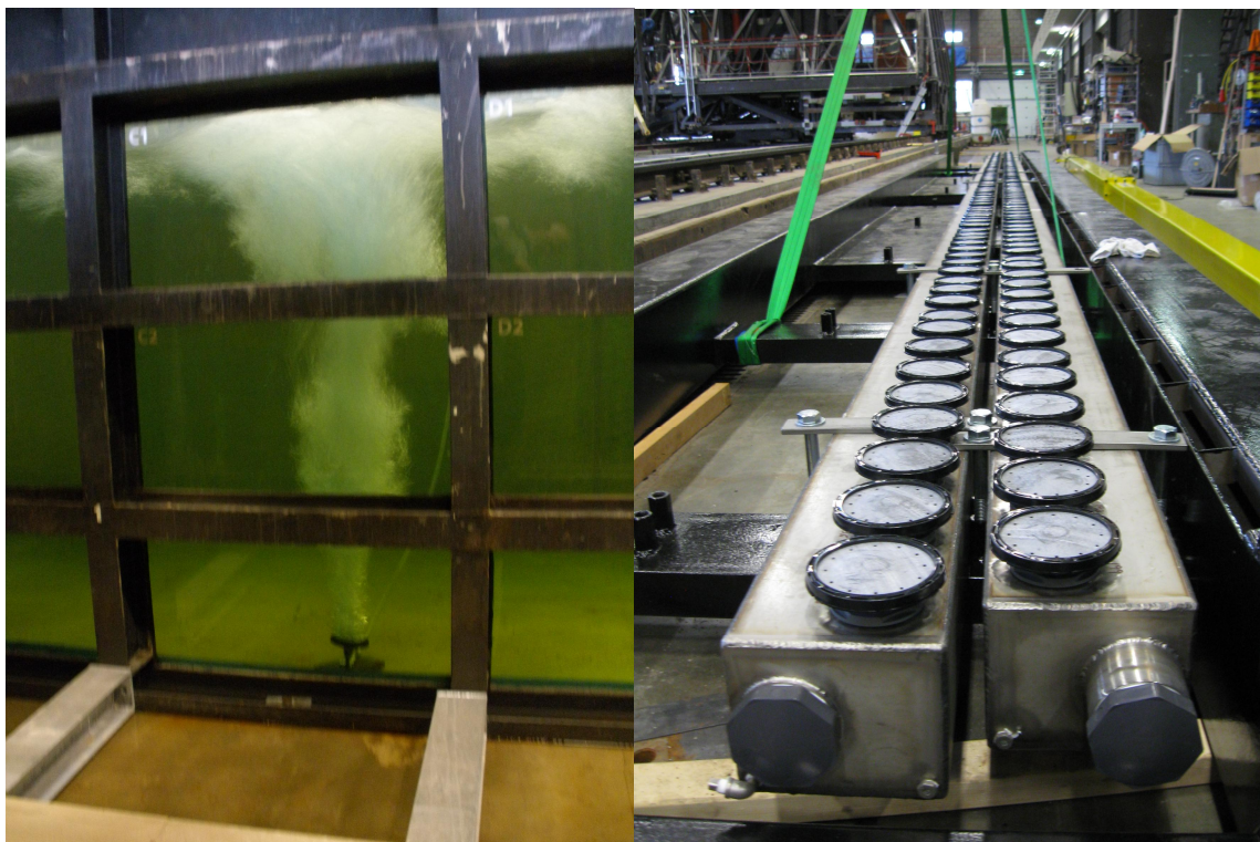
Foto 4.2 Het luchtbellenscherm dat in de praktijkproef gebruikt wordt. Links een visualisatie van het luchtbellenscherm dat gegenereerd wordt door een enkele sproeikop. In de praktijkproeven kan zowel een dubbele rij sproeikoppen ingezet worden zoals rechts is weergegeven of een enkele rij.
