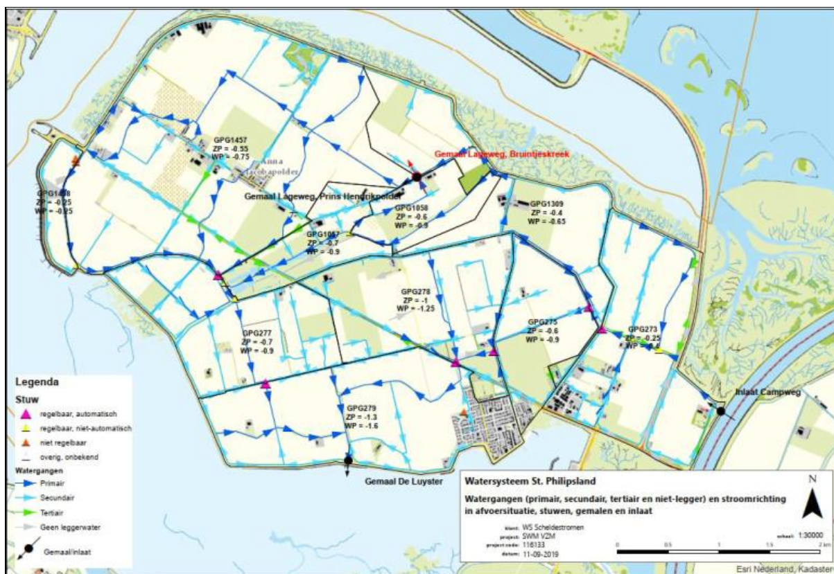
Figuur 34 Watersysteemkaart van Sint Philipsland inclusief stuwen, gemalen, watergangen en stroomrichting in afvoersituatie (Witteveen+Bos, 2019).
