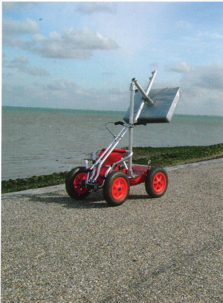
De L-band microgolvenradiometer in actie op een dijk.
