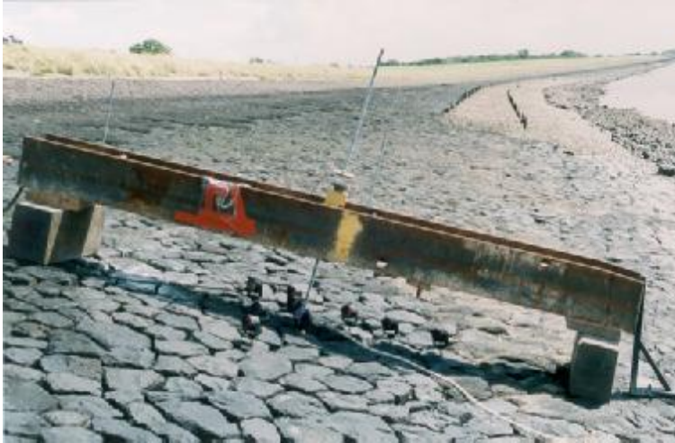
Figuur 4.4 Uitvoering trekproef
