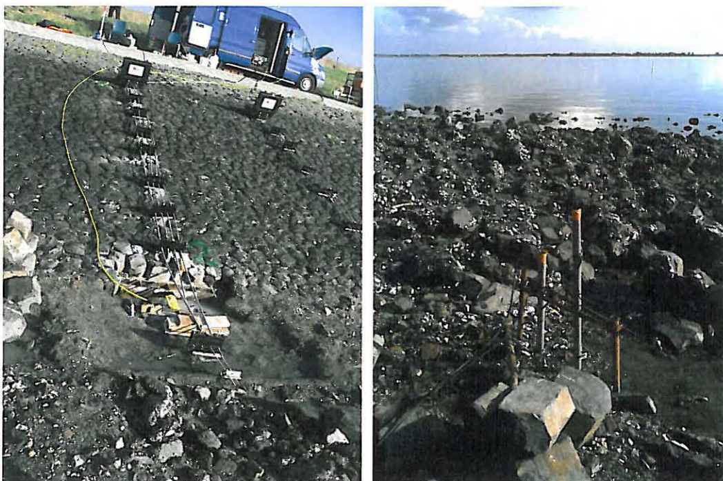
Figuur 6 Foto meetlocatie bij Ouwerkerk met twee clusters met verplaatsingsopnemers, en foto van het voorland met de opstelling van de waterspanningsmeters
