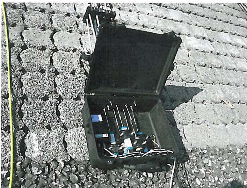
Figuur 4 Box met de verplaatsingsopnemers
