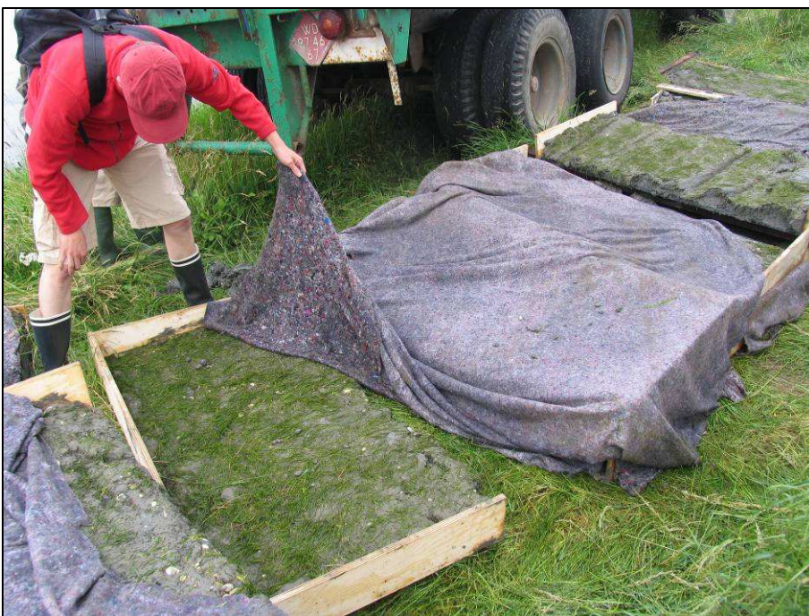
Figuur 5 Afdekken van plaggen met een natte deken
