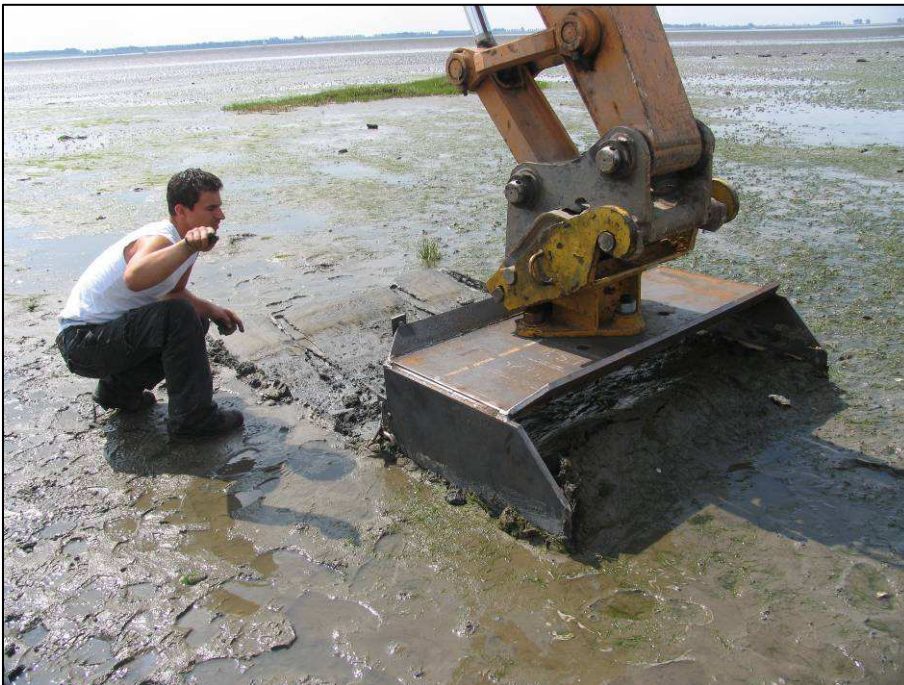
Figuur 3 Plaggenrooier in werking op donorlocatie
