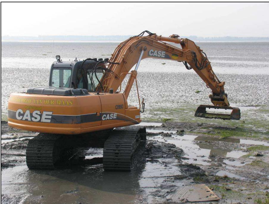
Foto 2 Viane: Rooien van zeegrasplaggen met behulp van een kraan
