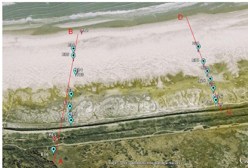
Figuur 6.2. Ligging van de meetraaien AB en CD, met de peilbuizen PB1-PB5 en een deel van de spiraalboorpunten B1-B36. De in november 2012 bemonsterde meetpunten staan in deze figuur.
