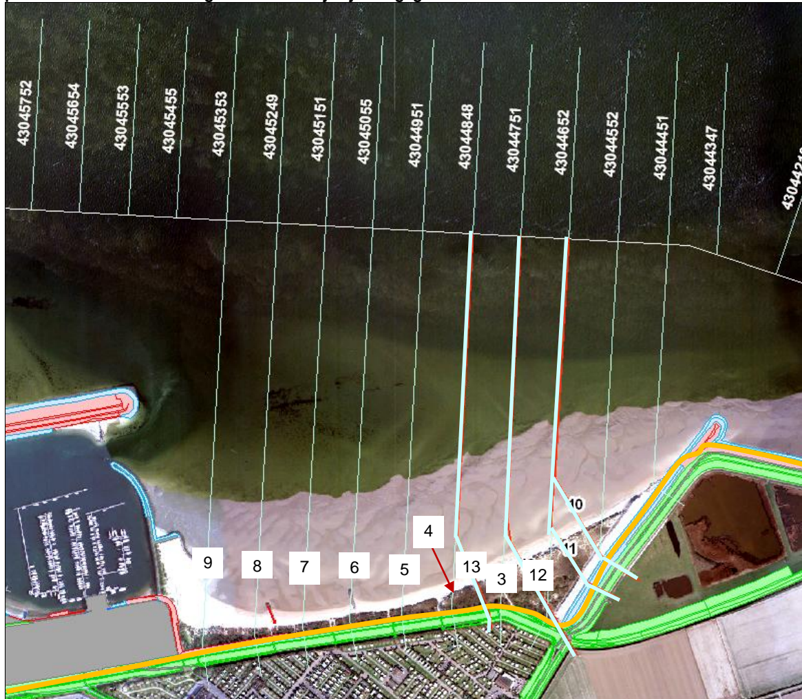
Figuur 9: Ligging primaire waterkering en dwarsprofielen, strand en duin bij Roompot (Bron: Google Earth), de primaire 'harde' waterkering is met de oranje lijn aangegeven
